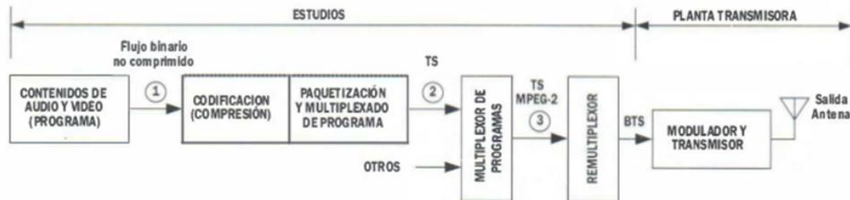
**Figura 3.1.4:** Diagrama funcional simplificado de una estación de Televisión Digital. [2]
