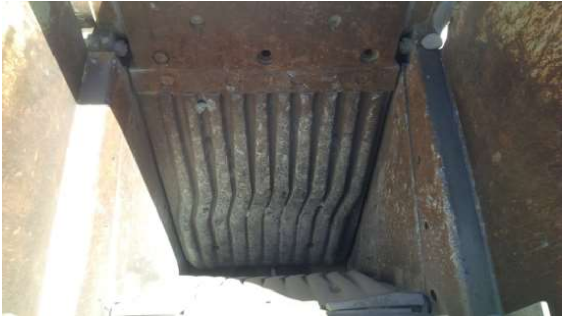
Figura 20. Desgaste presente en la trituradora de mandíbula. Elaboración: Propia.
