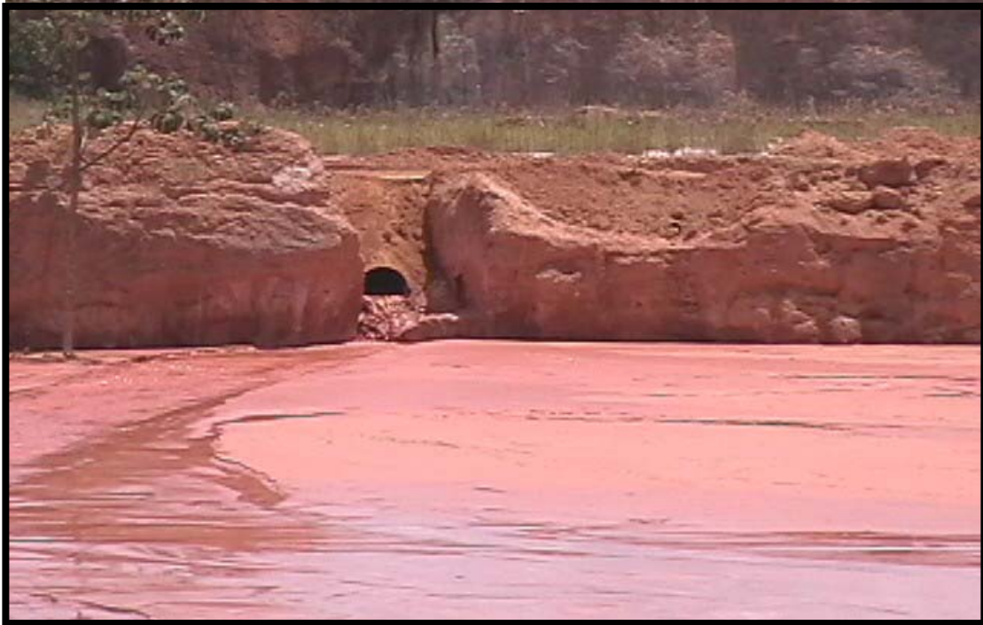
Fig. 29. Depósitos de finos y extrafinos descargados en una piscina sin control ambiental.
