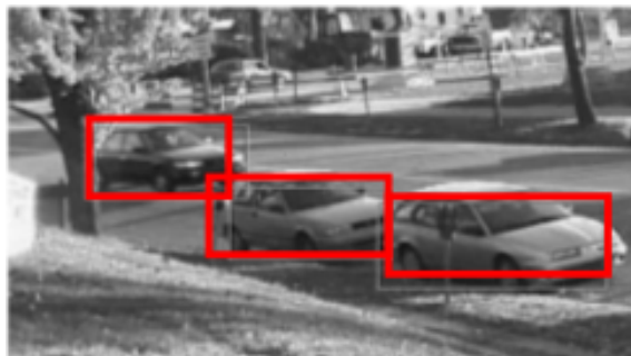
Figura 23. Detección de vehículos con la clasificadora en cascada.
