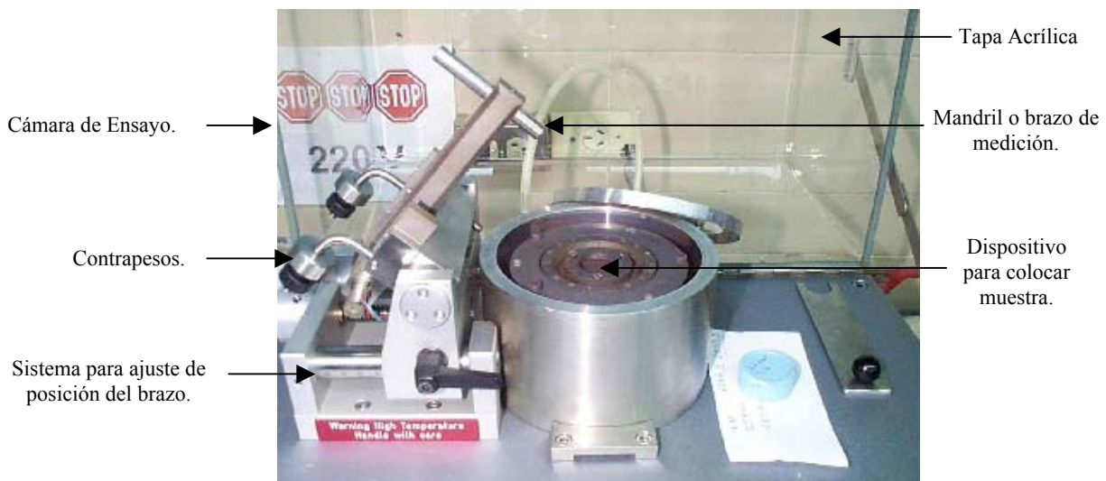
Fig.2.7 Unidad de ensayo del Tribómetro de alta temperatura.
