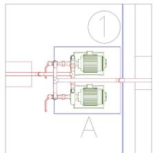
VISTA SUPERIOR DEL SISTEMA DE BOMBEO Y DISPOSICIÓN DE LAS TUBERÍAS DE SUCCIÓN Y DESCARGA. (CODOS, VÁLVULAS CHECK, TEE, LLAVES DE 3/4 DE VUELTA, BOMBAS CENTRÍFUGAS PARA DIESEL) ESCALA 1:30
