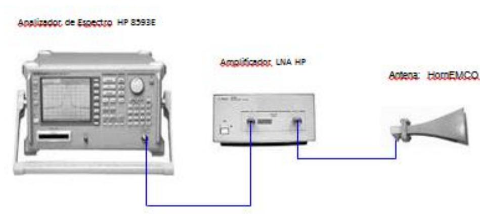
Figura N° 44. Método de medición para la espectrometría.
