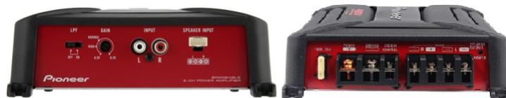
**Figura 4.8.** Amplificador de potencia Pioneer GM-3602. Izquierda (vista trasera) y Derecha (vista frontal)
