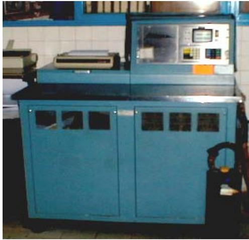
**Figura 19.** Probador de alta descarga Bitrode CT-1300.
