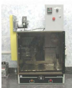
**Figura 16.** Equipo Tumbler® para la determinación de la absorción de ácido en óxido de plomo.
