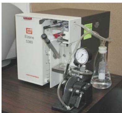
**Figura 18.** Equipo Micromeritics® ELZONE 5380 para la determinación de la distribución del tamaño de partículas.
