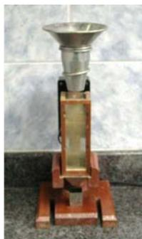
**Figura 12.** Dispositivo para la determinación de la densidad aparente en óxido de plomo.
