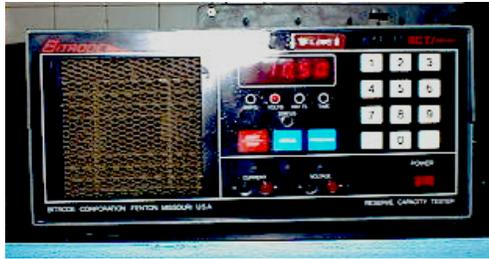
**Figura 15.** Probador de capacidad de reserva Bitrode RCT/MICRO.
