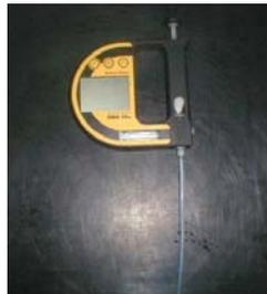
**Figura 11.** Densímetro digital Anton Paar DMA 35N.
