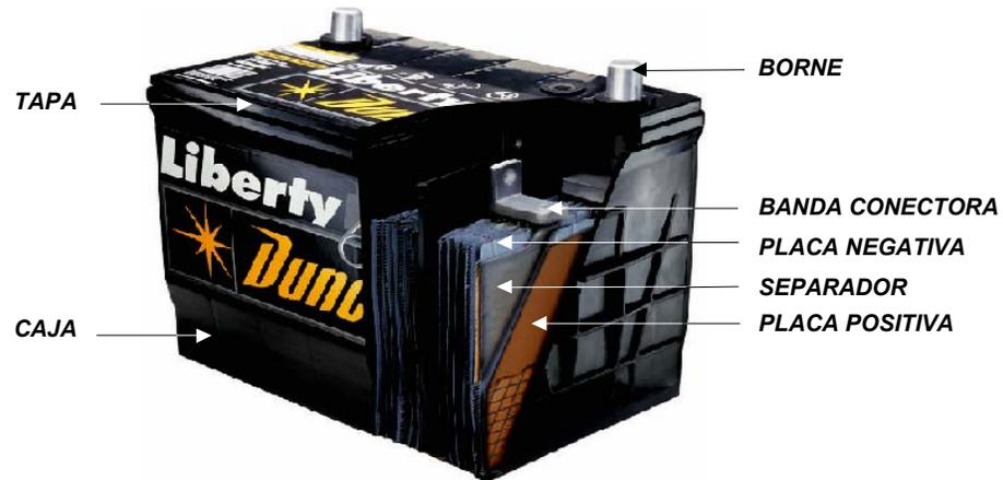
**Figura 3.** Elementos que constituyen la batería de plomo-ácido.
