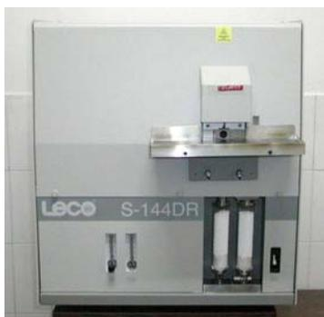
**Figura 17.** Equipo LECO® 144DR para la determinación de la de la cantidad de sulfatos.
