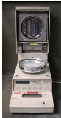
**Figura 14.** Balanza para la determinación de humedad.
