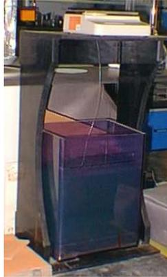
**Figura 13.** Dispositivo para la determinación de la densidad aparente del material activo en placas.
