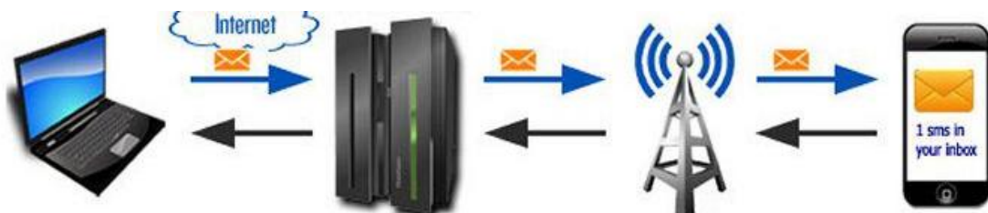
Figura 8.4: Esquema de flujo de un SMS Gateway
