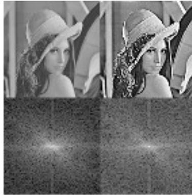
Figura 3.12: Aplicación de un filtro no-lineal en el espacio de las frecuencias.
