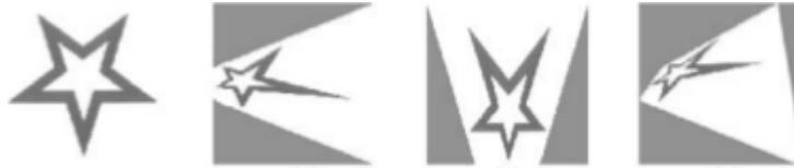
Figura 3.14: Aplicación de una transformación proyectiva.
