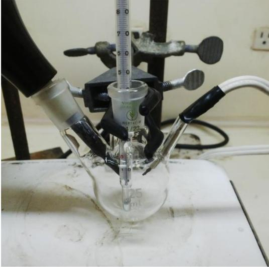
**Figura 13:** Matraz de tres bocas de 25ml (contenedor de la muestra)
