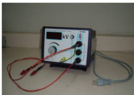
Figura 23. Fuente de poder usado para la aplicación de campo eléctrico DC (De Almeida y Rodríguez, 2006)
