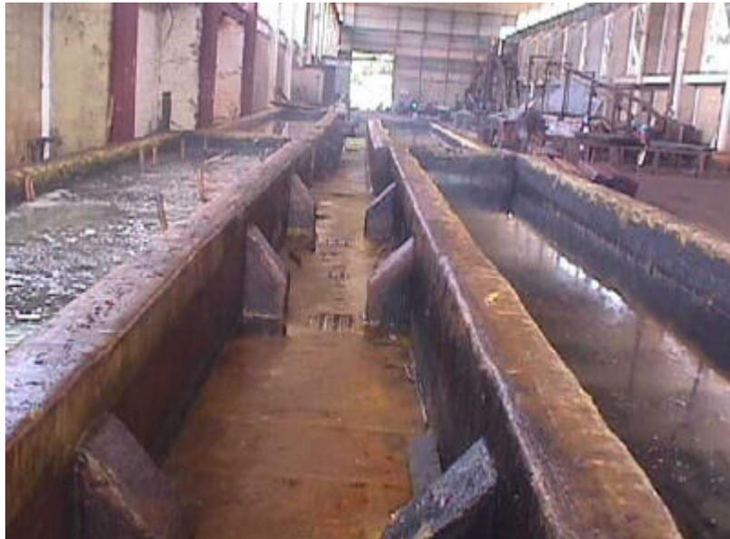
**Figura N° 11:** Operaciones de decapado y lavado en ABB
