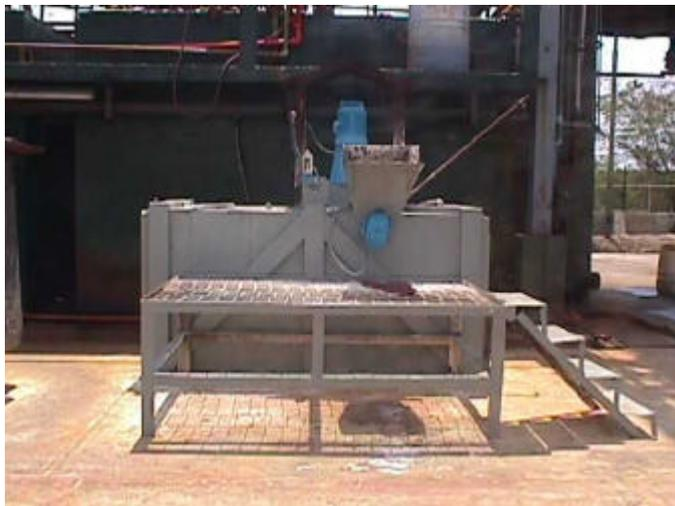
*Figura N° 18: Mezclador de cal*
