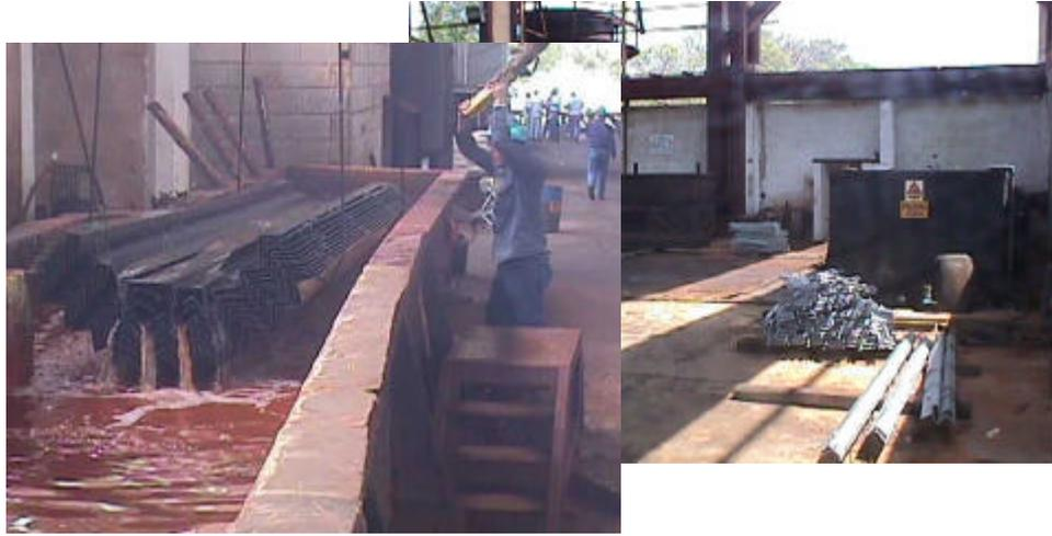
***Figura N° 12: Operaciones de flux y quemado en ABB***
