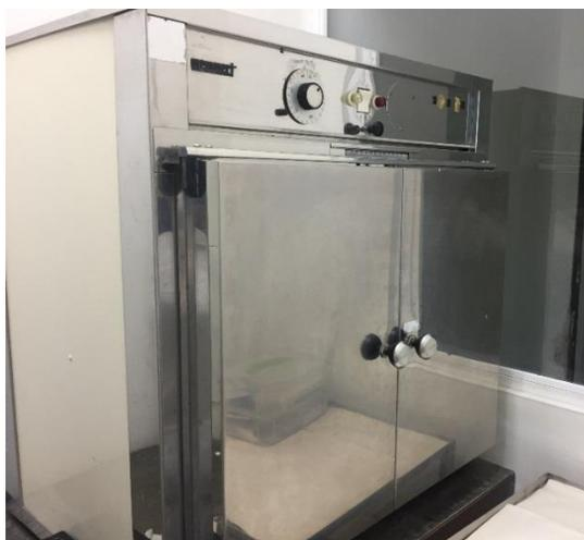
**Figura 10.** Incubadora de laboratorio para el secado de los discos de antibióticos elaborados.
