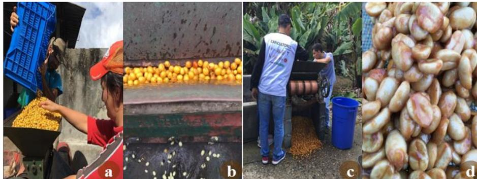
**Figura 10.** Etapas del proceso de despulpado. Carga de la tolva de la máquina (a), detalles del proceso (b), ejecución del proceso por los operarios (c) y fruto listos para el secado (d).
