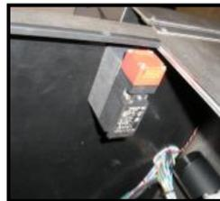
Figura 33. Llave de seguridad de la compuerta del Rayos X.
