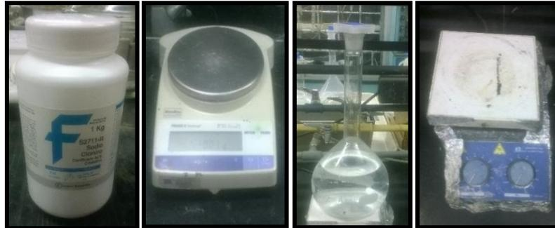
Figura 66. Preparación del Agua sintética de formación (Sal (NaCl)/Balanza/Balón Aforado/Agitador).
