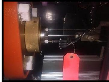
Figura 70. Coreholder conectado a línea de salida de confinamiento, líneas de descarga y termocuplas.
