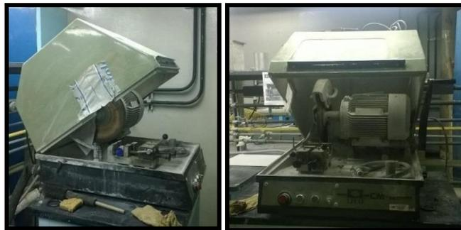
Figura 62. Cortadora manual de muestras consolidadas.
