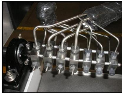
Figura 55. Conexiones de manta de calentamiento.
