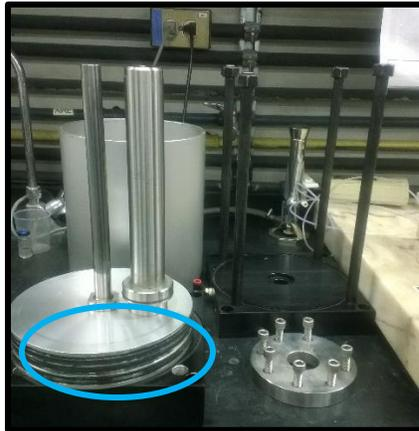
Figura 90. La cámara de vacío desarmada del sistema de confinamiento.
