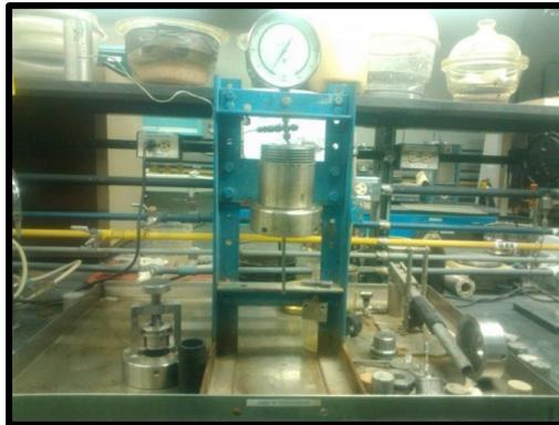
Figura 83. Celda Triaxial de Confinamiento.
