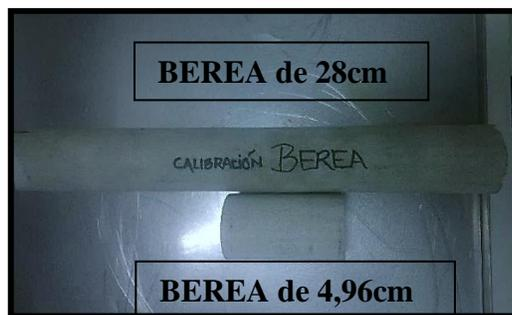
Figura 63. Muestras cortadas para determinados tamaños.
