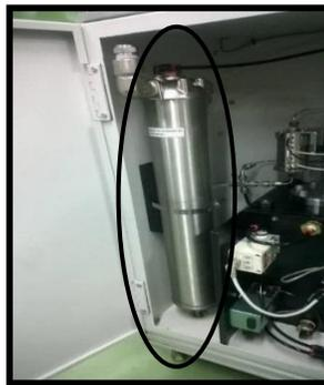
Figura 71. Depósito de suministro de fluido de confinamiento.
