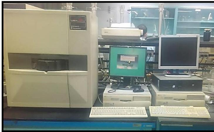
Figura 68. Equipo poro - permeámetro automatizado CMS-300.
