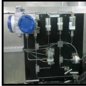
Figura 76. Panel de medición de presión aguas arriba y aguas abajo.
