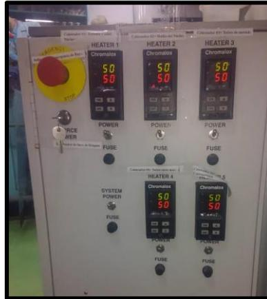
Figura 56. Controladores de calentamiento a 50°C.
