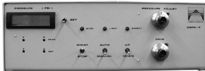
Figura 38. Unidad de control electrónico DBPR.
