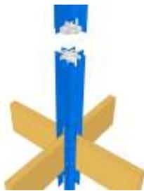
Fig. 15: Unión columnas y nodo rígido. Fuente: elaboración propia.
