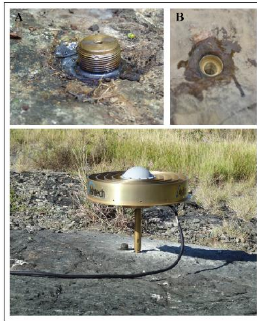
Figura II.9: Arriba Dispositivos de latón plantados en afloramientos estables. (A) Modelo de rosca externa y (B) modelo de rosca interna. Abajo Antena modelo Choke Ring instalada en el vértice MAN1 (Punta Manzanillo, Nueva Esparta)
