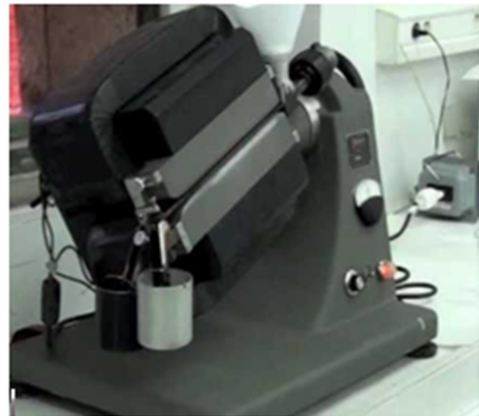
Figura 28. Ilustración del separador isodinámico Frantz y sus partes, (j) Foto del separador Magnético Frantz, existente en el Laboratorio de Termocronología de la UCV.
