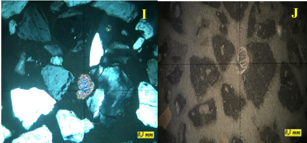
Figura 41 I) Vista de cristal de Esfena NX; J) Cristal de Esfena alterado a Leucoxeno, visto con luz blanca.
