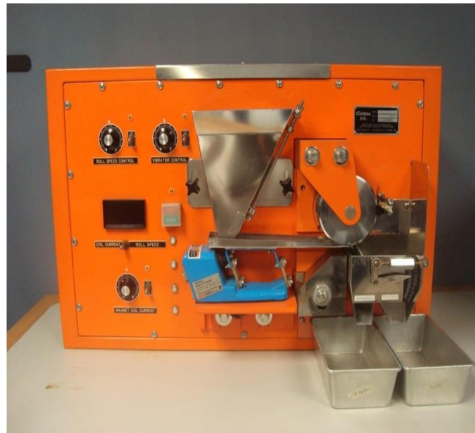
Figura 26. Separador Magnet–lift, Carpo MLH (13) 111-5. T. laboratorio de termocronología de la UCV.
