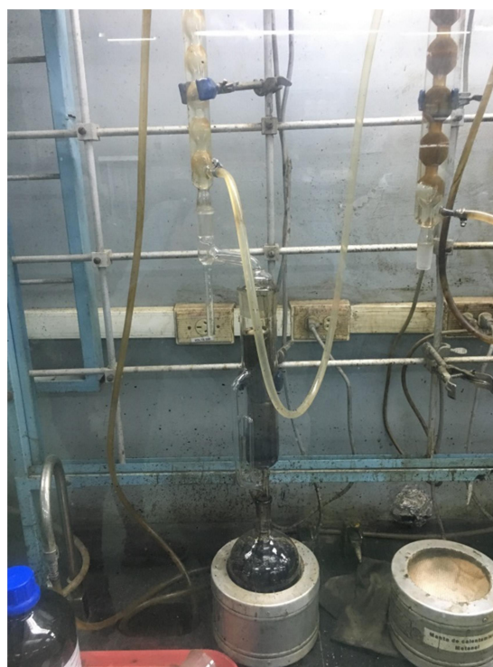
Figura 23. Montaje experimental para la extracción de materia orgánica por medio de la técnica Soxhlet.
