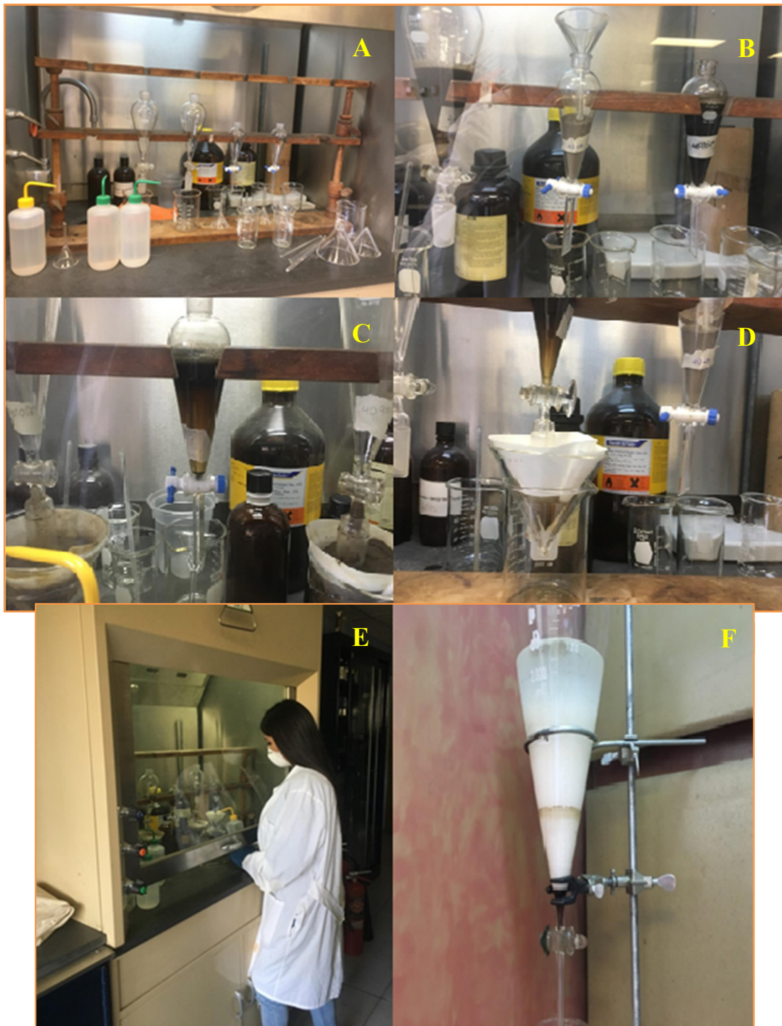
Figura 27. A) Materiales utilizados para la separación por densidad. B) Muestras de arenas secas antes de verter el líquido pesado para la separación. C) Separación de los minerales pesados, livianos suspendidos y pesados al fondo del embudo.
