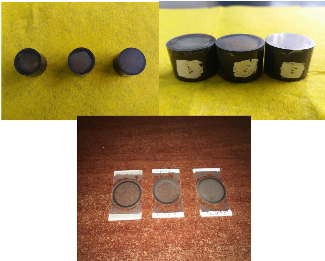
Figura 29. Proceso de montaje de minerales pesados en sección fina para análisis petrográfico para las muestras 4098' en la fracción 1.2 no magnética y no magnética y 4103' en la fracción 1.2 no magnética
