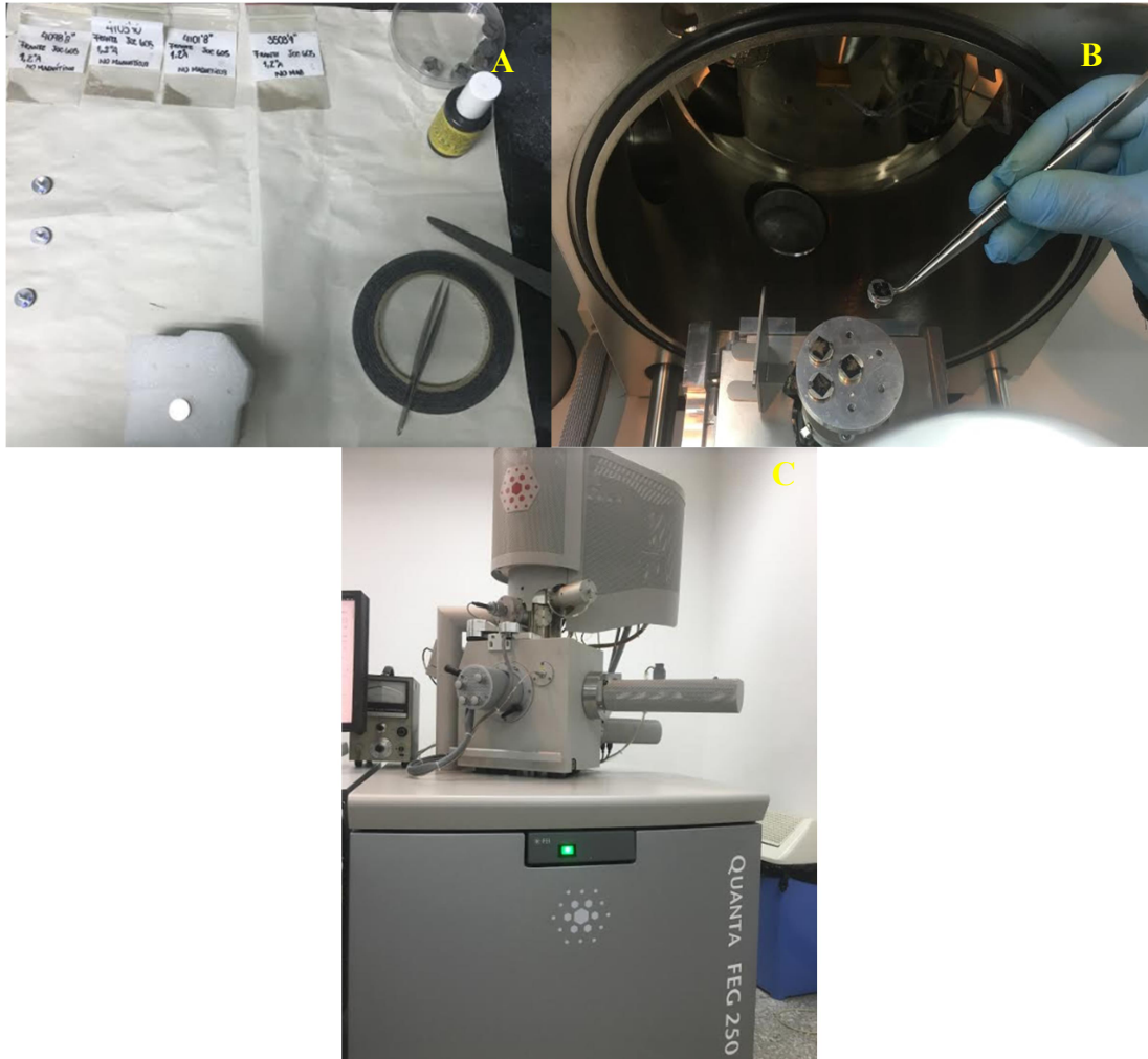
Figura 34 (a) Montaje de muestras para MEB, (b) Muestras en disco en la cámara del equipo, (c) microscopio electrónico de barrido ambiental Quanta FEG 250 (ESEM)
