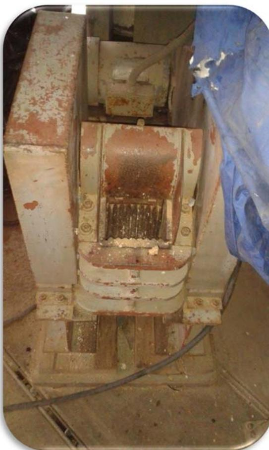
**Figura. 3.1** Trituradora de dientes, Laboratorio de Metalurgia UCV.
