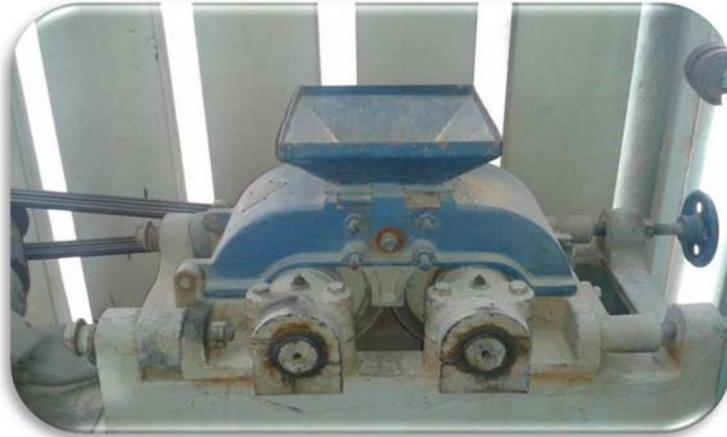
**Figura. 3.2** Trituradora de Rodillos, Laboratorio de Metalurgia UCV.
