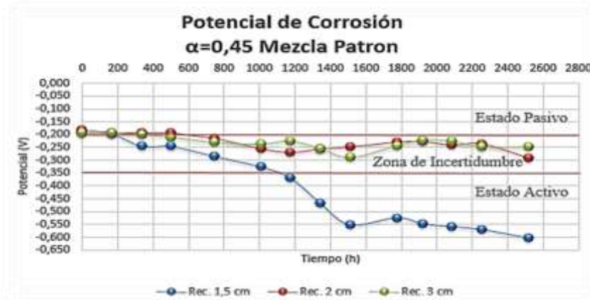
Figura 8. Comportamiento de los tres espesores de recubrimientos para probetas de concreto con \alpha=0,45 .
