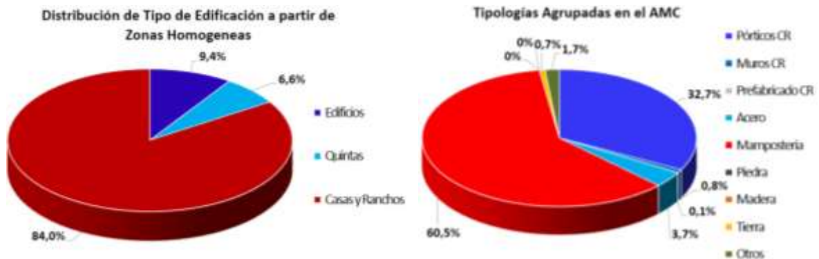
Figura 11. Resultados preliminar de Distribución de Tipo de Edificación (izquierda) y Tipologías (derecha) a partir de Zonas Homogéneas e Inspecciones en el AMC.
