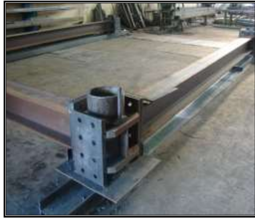
Foto No.4: Preparación de una Conexión para Columna Tubular Circular y vigas IPE de acuerdo a CIDECT No.9
