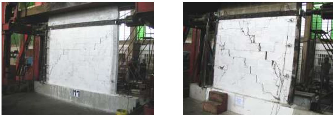
Figura 2: Muros de mampostería confinada con elementos de concreto reforzado (izquierda) y con perfiles de acero (derecha) ensayados ante carga lateral (Fotografías A. Marinilli y E. Castilla).
