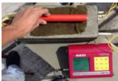
Figura 4 Medición de la resistividad eléctrica.
