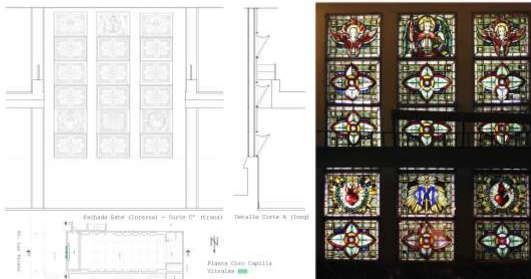
Figuras 1 a-b: a) Levantamiento de líneas esenciales Conjunto Vitrales Este en planta, corte y alzado (sin escala). b) Referencia a la base fotográfica utilizada para su realización.
