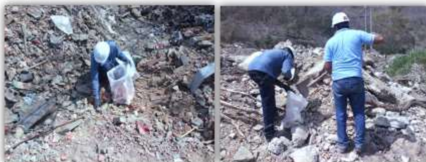
Figura 3 Toma de muestras selectiva en sitio. Fuente: Elaboración Propia
