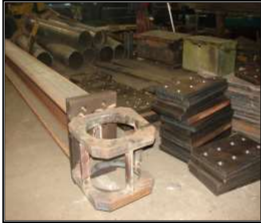
Foto No.4: Preparación de una Conexión para Columna Tubular Circular y vigas IPE de acuerdo a CIDECT No.9
