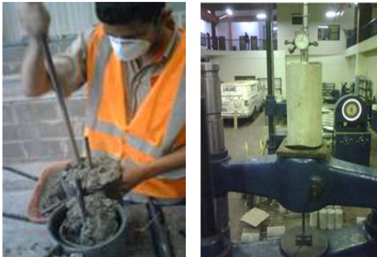
Figura 7. Fotografías a) Elaboración de probetas de adherencia; b) Ensayo de adherencia. Fuente: Elaboración propia.
