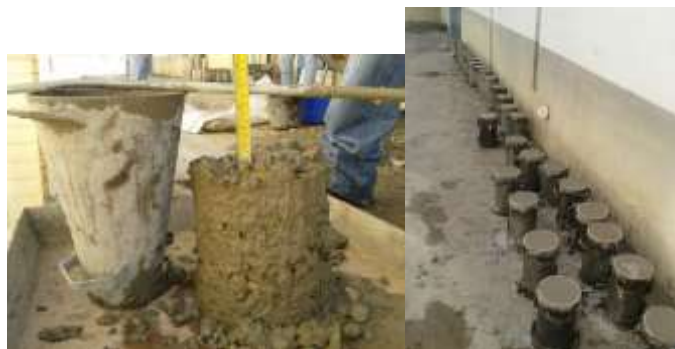
Fig. 1 Asentamiento del concreto y probetas
