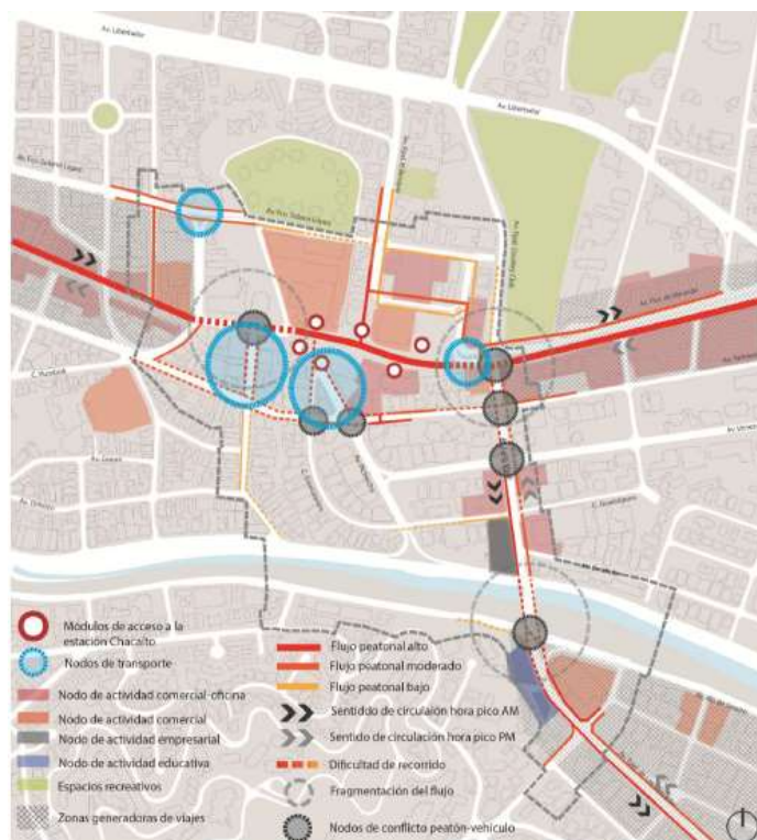
Figura 3: Síntesis evaluación de la calidad peatonal del caso de estudio. Fuente: Escobar, 2015.
