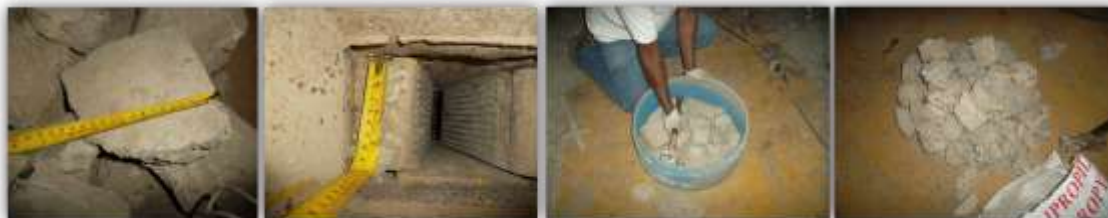
Figura 4 Tratamiento Previo. Pre- trituración y homogenización manual.
