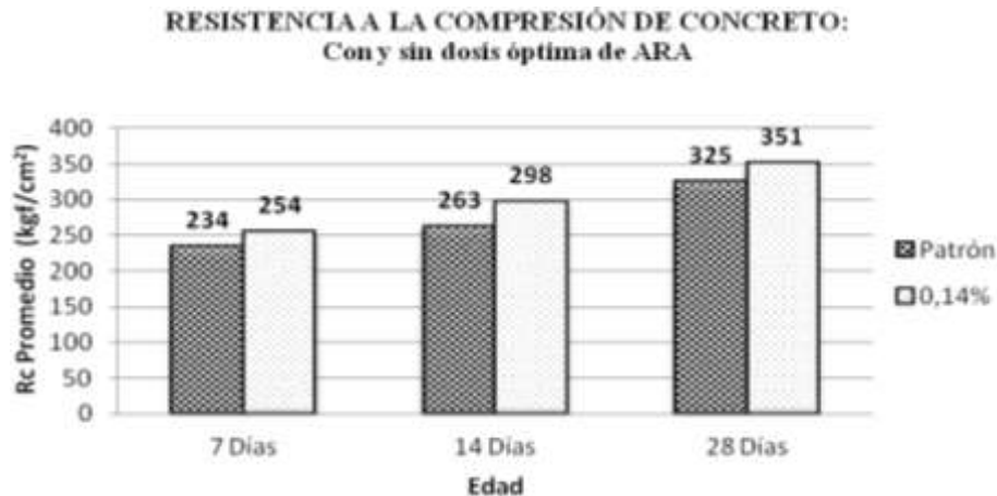
Figura 3. Resistencia a la compresión de concreto con y sin dosis óptima de ARA. Fuente: Elaboración propia.
