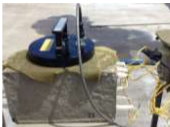
Figura 3. Medición de velocidad de corrosión con GECOR 6.
