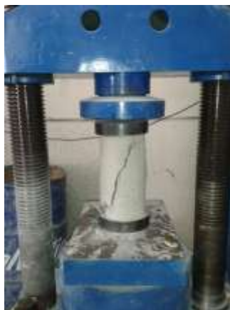
Fig. 3 Ensayo a compresión de probetas.
