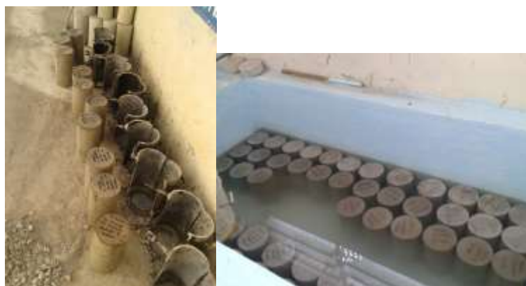
Fig.2 Desencofrado y curado de probetas
