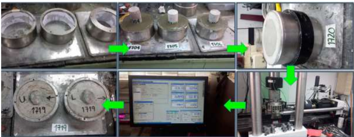
Figura 4.11 Procedimiento para el ensayo de corte directo (Aranguren Otero & Lacruz Paredes, 2016)
