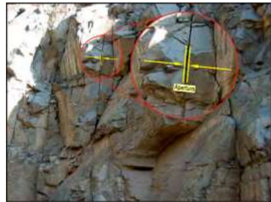
Figura 2.13 Apertura de una discontinuidad
