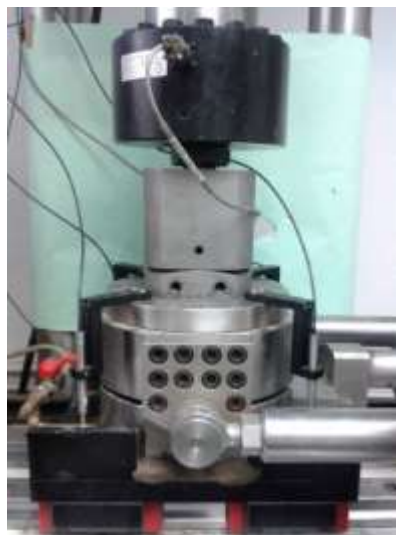
Figura 4.4 Equipo para realizar ensayo de corte directo, sin los retenedores, para establecer todos los grados de libertad de movimiento del cabezal
