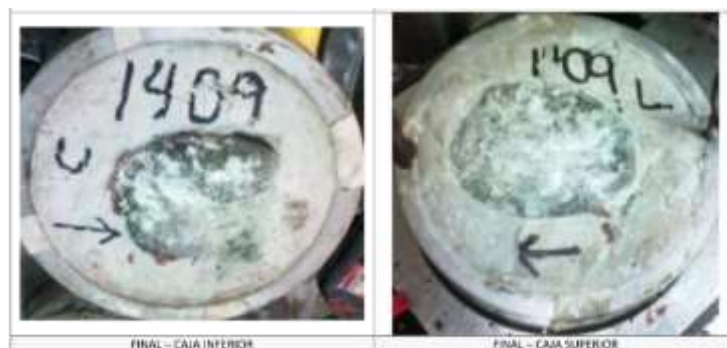
Figura 5.31 Caras del Especimen 1409-C_DSH, una vez finalizado el ensayo - Cerro La Danta
