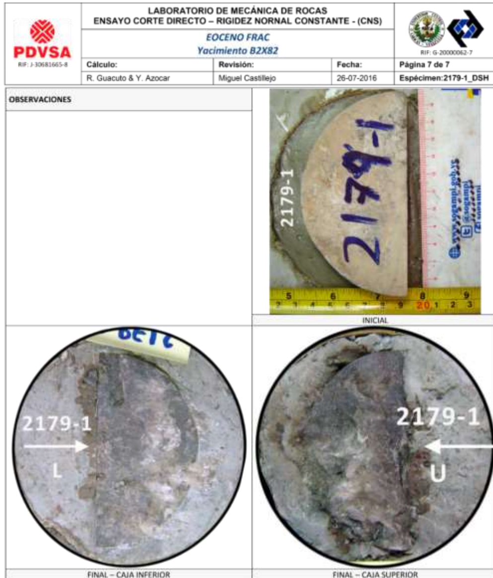
Figura 4.26 Página 7 del reporte del Ensayo de Corte bajo la condición de Carga Normal Constante (CNS)
