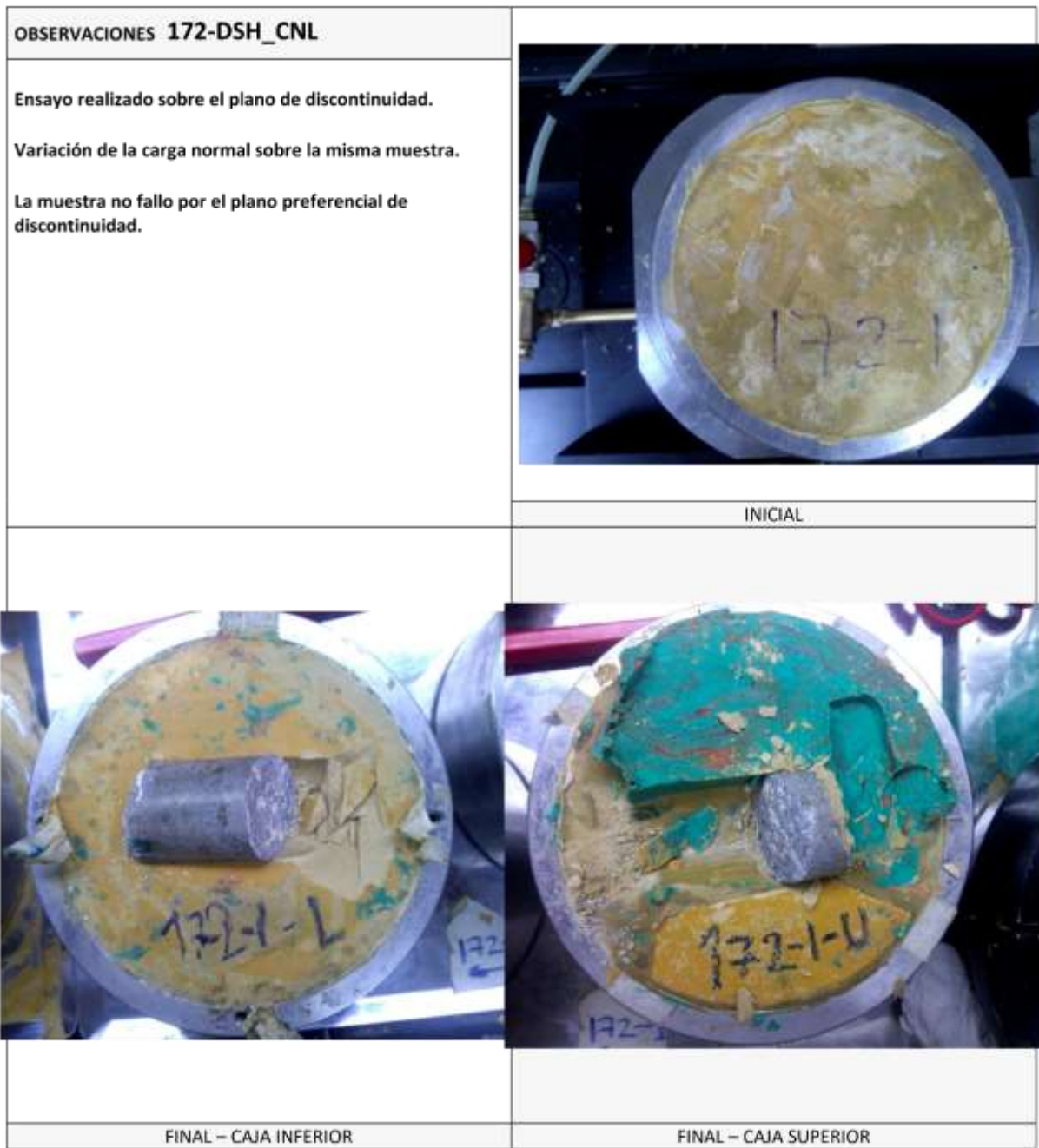
Figura 5.220 Tipo de factura generada en el espécimen 172-DSH _ Mina Colombia – El Callao
