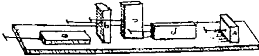
Figura 2.1 Estudios sobre fricción realizados por Leonardo Da Vinci, que demuestran que la fricción es independiente del tamaño de las superficies en contacto
