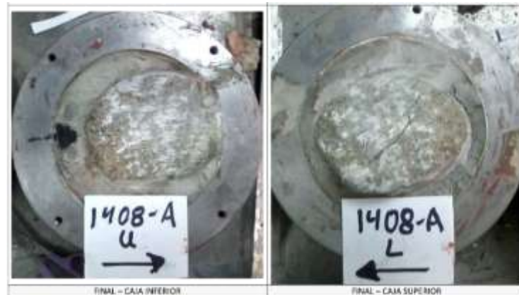
Figura 5.29 Caras del Especimen 1408-A_DSH, una vez finalizado el ensayo - Cerro La Danta
