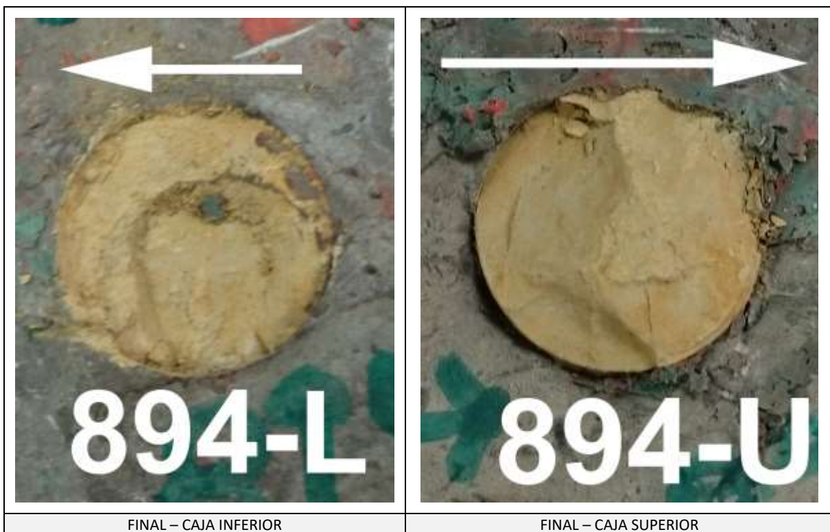
Figura 4.31 Condición final de las caras de la discontinuidad generada, después de haber sido sometida a los cuatro puntos de carga, bajo el comportamiento de carga normal constante (CNL), para el mismo espécimen presentado en la Figura 5.17, en un espécimen de los limos de la Formación Guatire (Estación Guatire 1).
