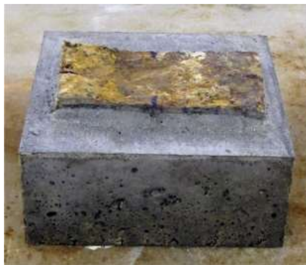
Figura 9.3 Mitad inferior de una discontinuidad encapsulada de un espécimen de forma rectangular
