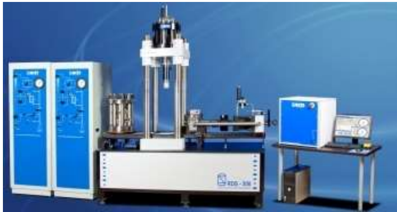
Figura 4.3 Sistema RDS-500 – Sistema de Corte Directo y Ensayo Triaxial
