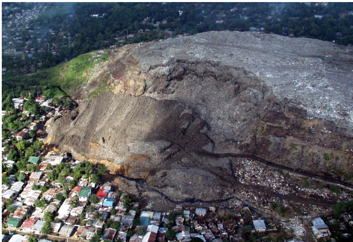
Foto 7.15. Vista aérea del Norte al sur del deslizamiento del relleno sanitario
