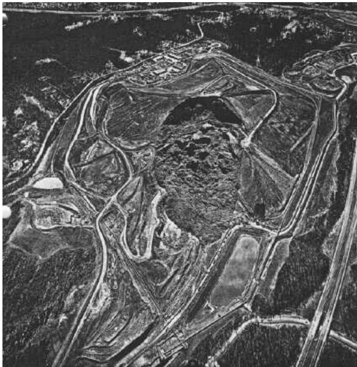
Foto 7.20. Vista aérea del relleno sanitario de Rumpke, después de ocurrir el deslizamiento
