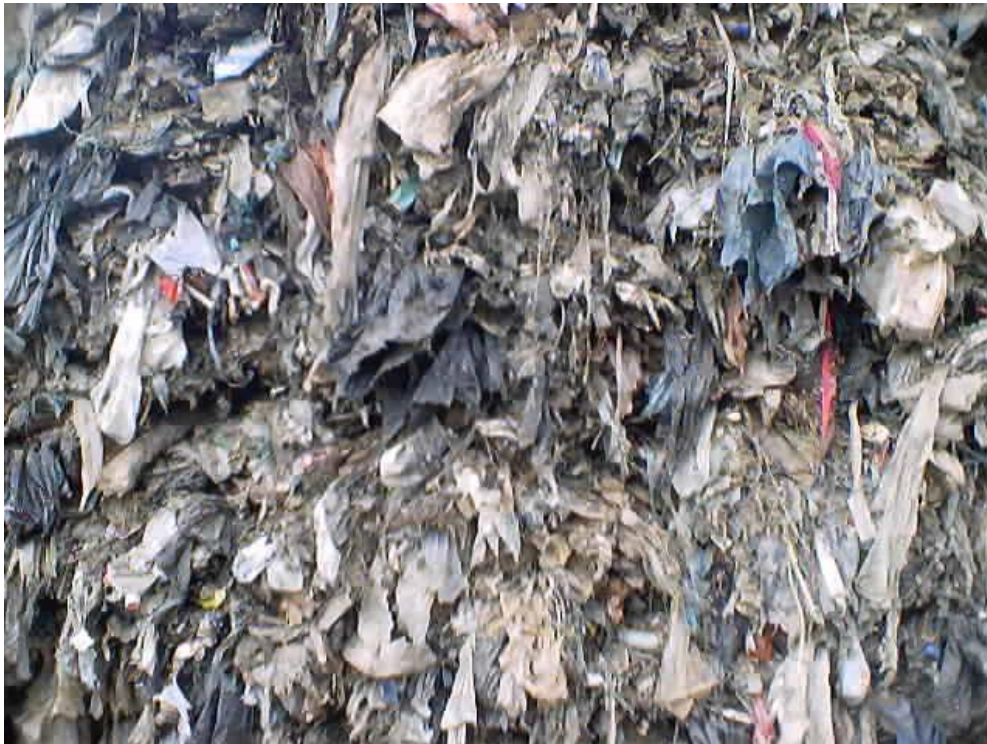
Foto 9.10. Cara del talud ensayado, puede verse que los desechos están orientados de manera perpendicular a la cara.
