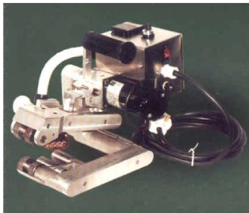
Foto 3.1. Equipo de doble soldadura por fusión con cuña caliente
