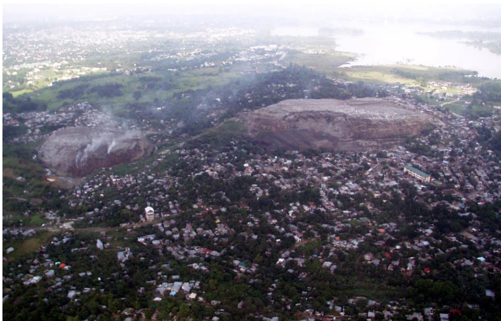
Foto 7.4. Vista de los dos rellenos sanitarios de Payatas, el pequeño ocupa una extensión de 5,3 hectáreas y está ubicado a la izquierda del principal que está a la derecha y tiene una extensión de 12,7 hectáreas. El deslizamiento puede verse en la parte frontal del relleno sanitario mayor. Los incendios, indicados por el humo en ambos rellenos, no fueron extinguidos cuando se iniciaron.
