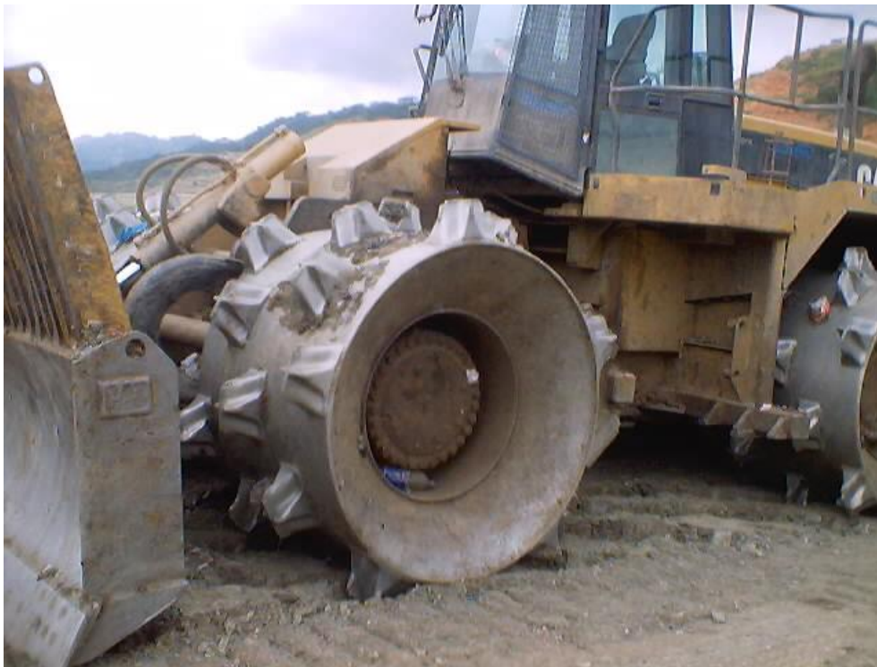
Foto 9.13. Detalle de los elementos compactadores de los desechos sólidos, su configuración permite la orientación preferencial.
