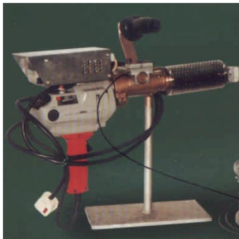
Foto 3.2. Equipo de soldadura por extrusión
