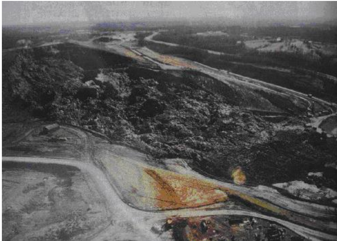
Foto 7.23. Área de expansión de los desechos sólidos después del deslizamiento
