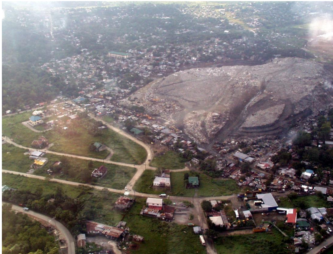
Foto 7.3. Vista noroeste del área de Payatas en la cual puede observarse el relleno sanitario en el centro. Un segundo relleno que está siendo iniciado puede verse en la esquina superior derecha.
