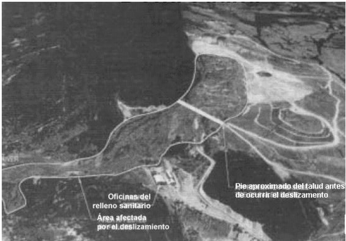
Foto 7.24. Fotografía del relleno de Doña Juana, en la cual se a delimitado la zona en la cual ocurrió el deslizamiento.
