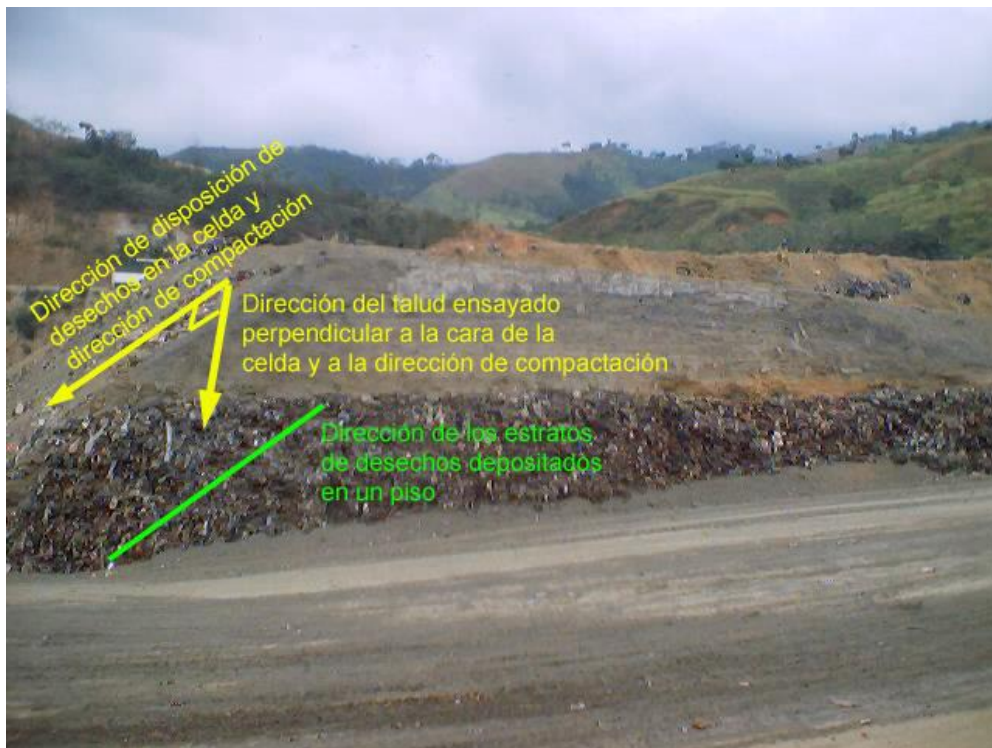
Foto 9.12. Dirección de disposición de avance de la celda con la dirección de compactación, también puede apreciarse que el talud ensayado es perpendicular a estas direcciones
