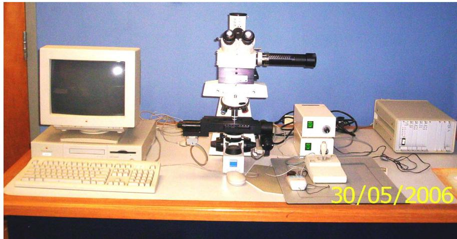
**Figura 5.** Microscopio con platina motorizada para el conteo de huellas de fisión, versión del Dr. Trevor Dumitru.
