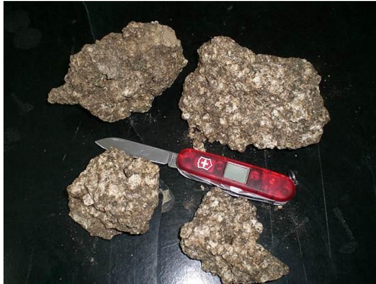
Figura 19. Granito con meteorización intermedia y deleznable, evidenciando la presencia de óxidos de hierro.
