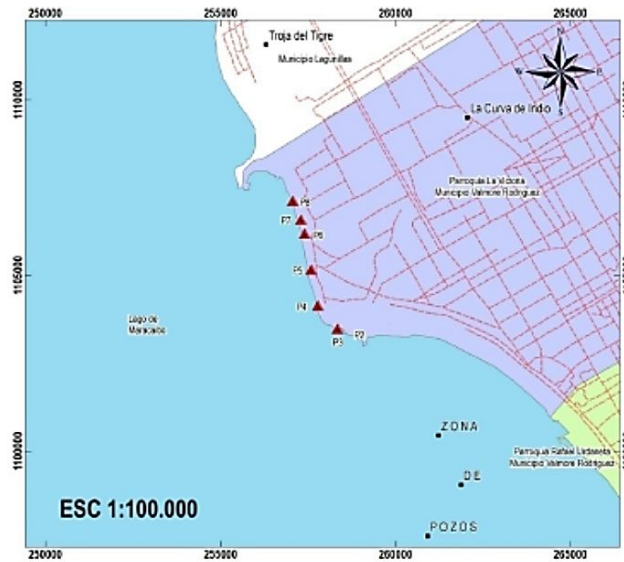
Figura 63. Área en Bachaquero (color azul), que abarca las seis perforaciones geotécnicas ubicadas en terreno natural del dique COLM a lo largo de la costa.
