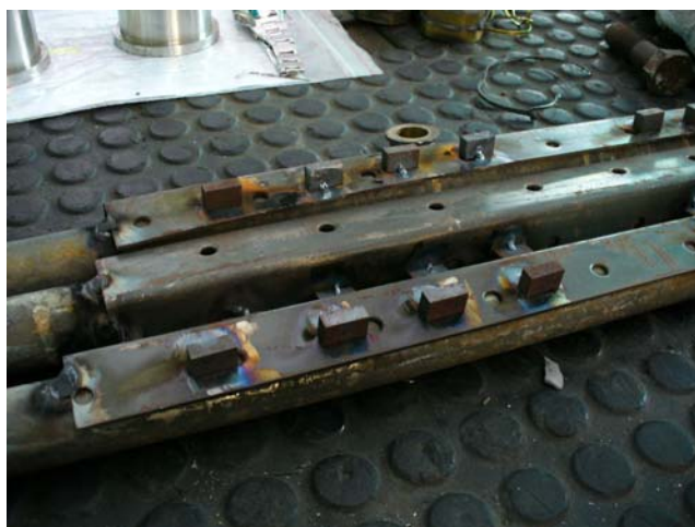
Figura 3-5. Bloques montados en los soportes de acero.
