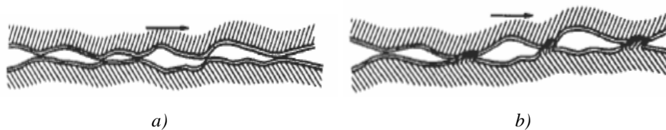
Figura 2-7. Desgaste adhesivo entre dos superficies: a) Deslizamiento simple b) Superficies fracturadas con interacción directa entre materiales.
