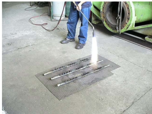
Figura 3-7. Precalentamiento de las muestras.
