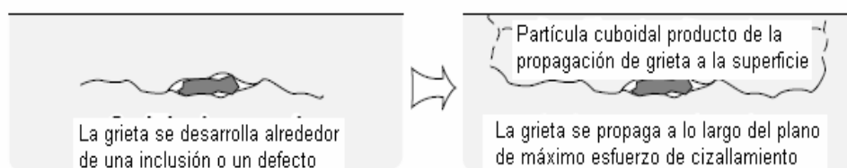
Figura 2-10. Propagación de grietas por fatiga de contacto rodante Subsuperficial.
