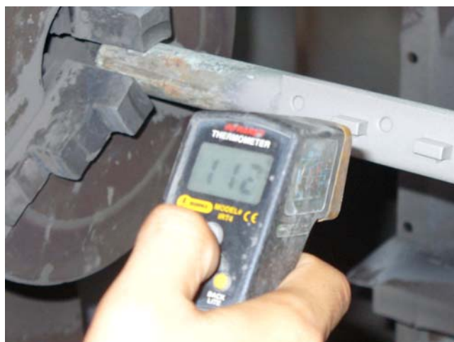
Figura 3-13. Medición de la temperatura de los bloques entre pasadas.
