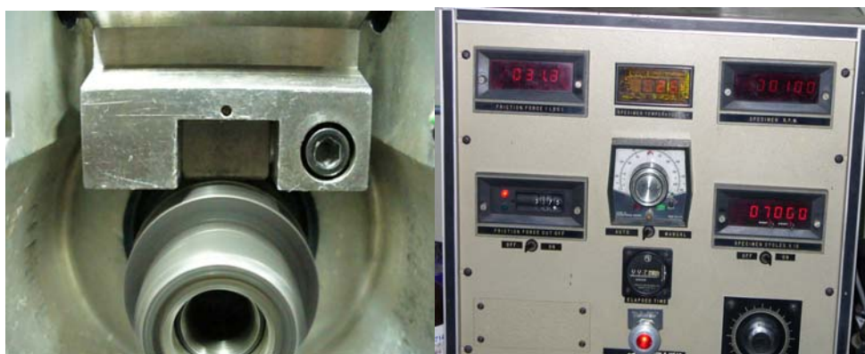
Figura 3-17. Acople Bloque-Anillo y centro de Control de la Máquina Falex.
