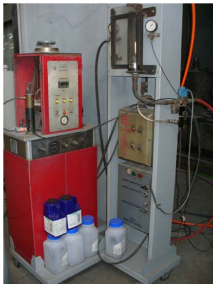
Figura 3-10. Equipo HVOF. De izquierda a derecha en sentido de las agujas del reloj: Alimentador de polvos, control de flujo de combustible y agua, control de la pistola y medidores de flujo de O 2 y kerosén.
