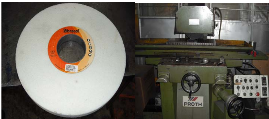
Figura 3-14. Disco de Diamantes y Rectificadora Tangencial.
