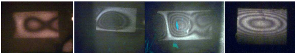
Imagen # 32; Hologramas del prototipo con patrones vibratorios.
