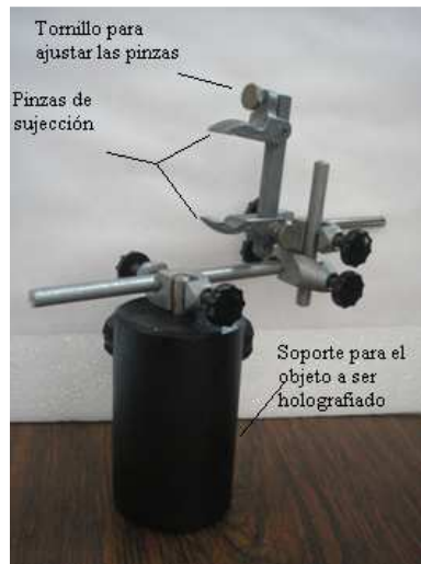
Figura # 39; Soporte colocado para holografías de las caras L2 y L5.
