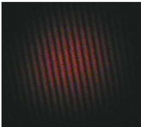
Imagen # 34; Patrón de franjas interferométricas.
