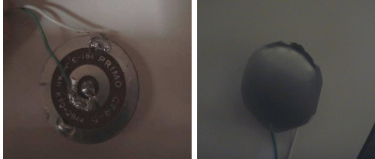
Imagen # 38; Piezoeléctrico utilizado en la experimentación.
