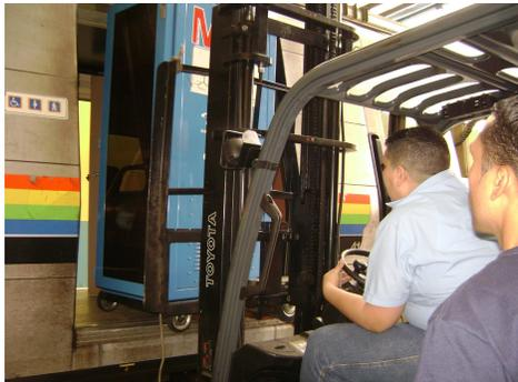
*Figura 19: Montaje en el tren del sistema de adquisición de datos en el vagón al igual que componentes pesado.*
