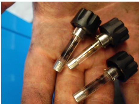
*Figura 20: Muestra de la condición de los fusibles de los amplificadores analógicos.*
