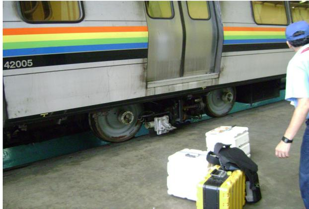
*Figura 17: Tren habilitado por Metro de Caracas C.A. para la realización de pruebas en la vía de prueba, el cual se le instaló el bogie instrumentados, sin los amplificadores en los extremos del eje.*
