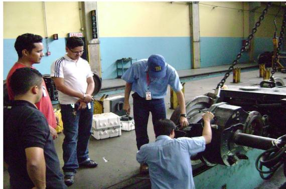
*Figura 18: Inspección del bogie instrumentado por el personal de mediciones especiales, a fin de garantizar el estado integral de las piezas mecánicas y el correcto aislamiento del sistema de amortiguación.*
