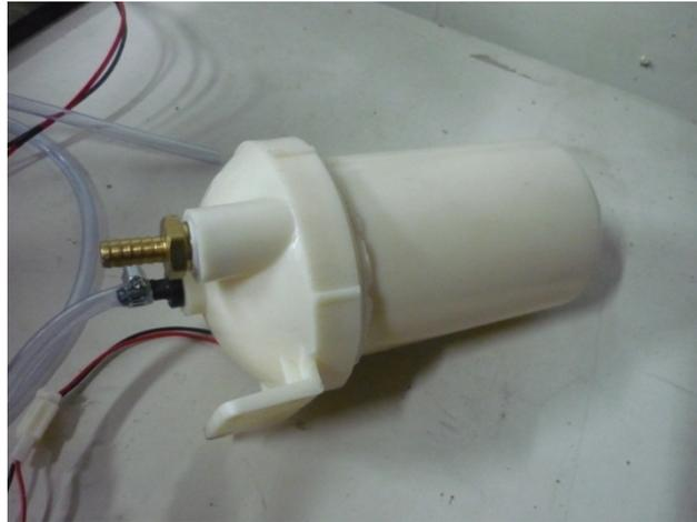
*Figura A 11.7. Filtro de carbón activado.*
