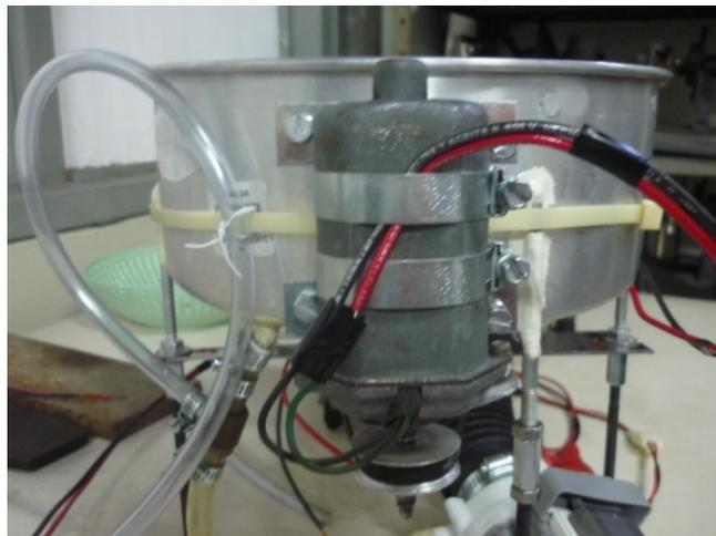
*Figura A 11.8. Motor acoplado a la olla.*
