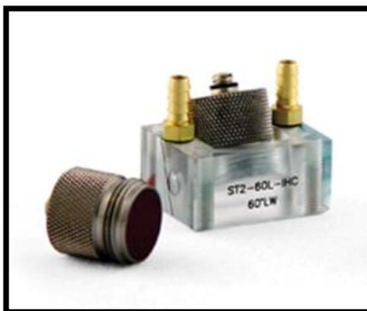
Figura 3.6. Zapatas y palpadores. <sup>[41]</sup>
