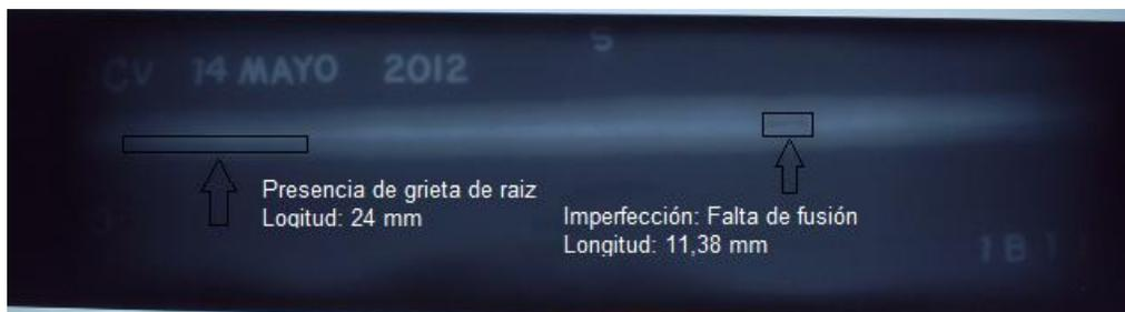
Figura 4.29. Radiografía realizada al patrón de referencia de la sección de lámina soldada.
