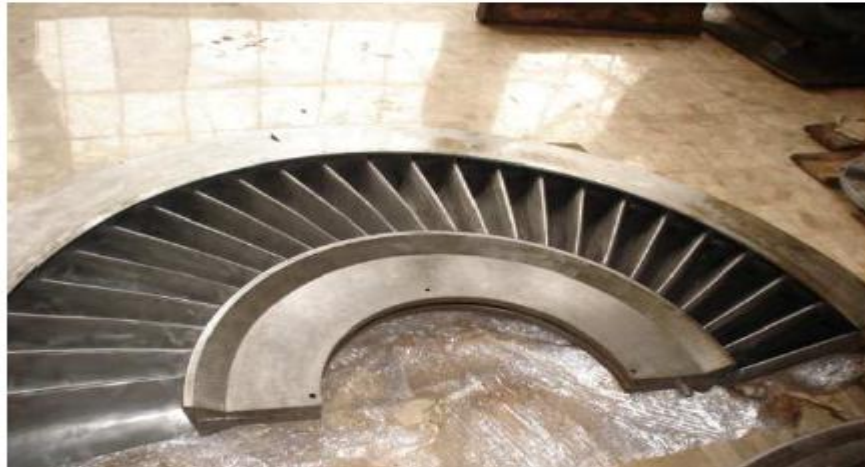
Figura 2. 6 Diafragma de una turbina de vapor Hitachi, etapa de baja presión
