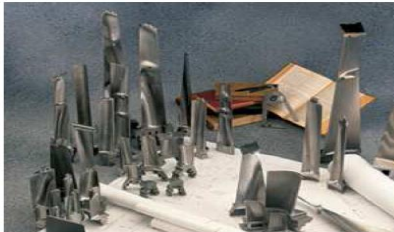
Figura 2. 4 Diferentes tipos de alabes móviles
