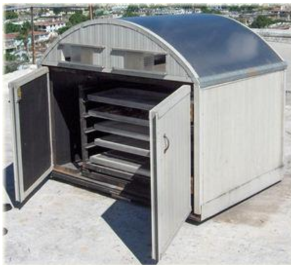
Figura 1. 7: Secador solar artificial (Bérriz, 1999)
