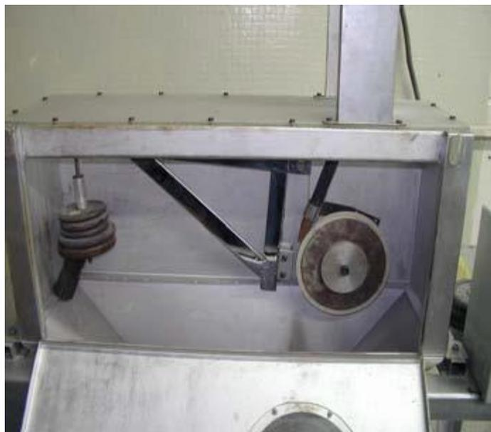
**Figura 3.3 Máquina de Ensayo de Abrasión.**
