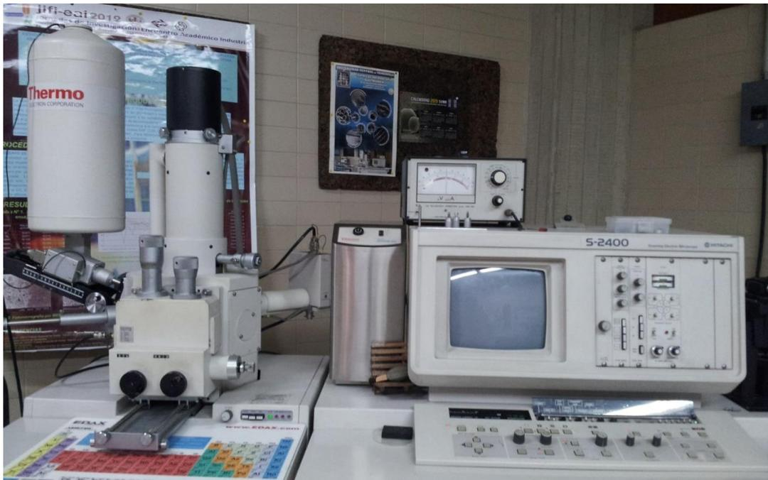
**Figura 3.9 Microscopio Electrónico de Barrido.**
