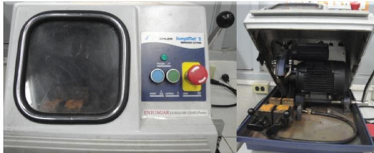
**Figura 3.6 Cortadora Metalográfica.**
