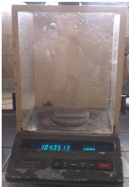
**Figura 3.5 Balanza Ainsworth AA160 con apreciación de 0.0001 g.**
