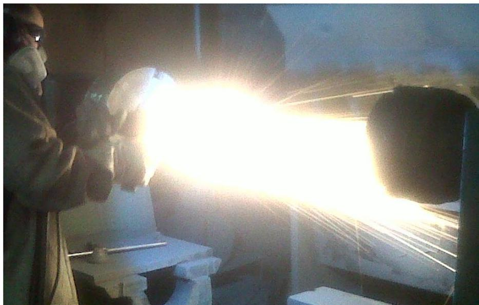
**Figura 3.2 Proceso de Rociado Térmico.**
