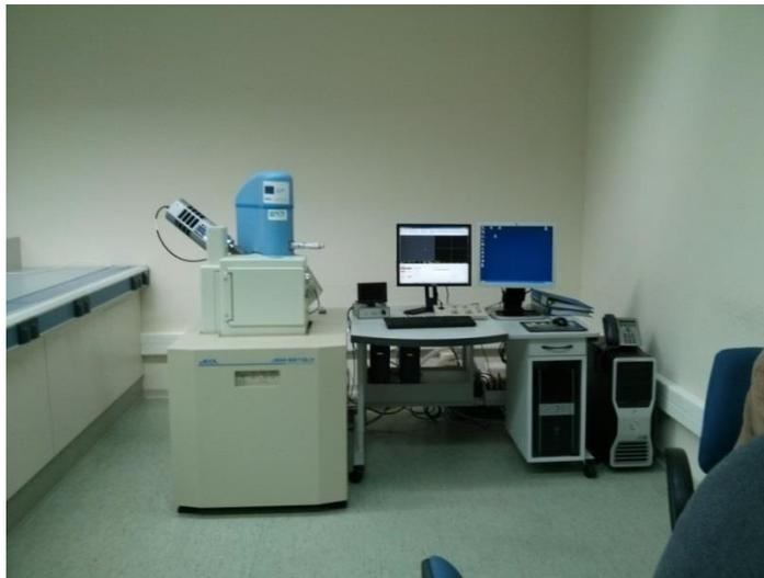
Figura 22. Microscopio electrónico de barrido
