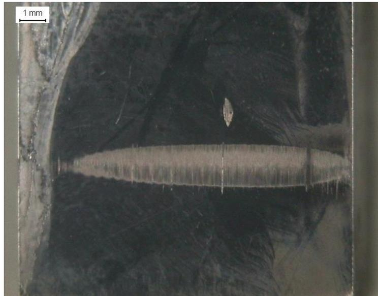
Figura 61. Huella de desgaste aceite telex 68 + 0,5% ZrO<sub>2</sub>
