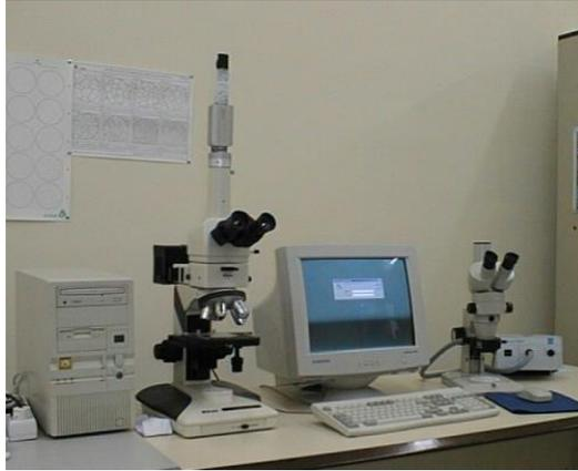
Figura 21. Microscopio metalográfico
