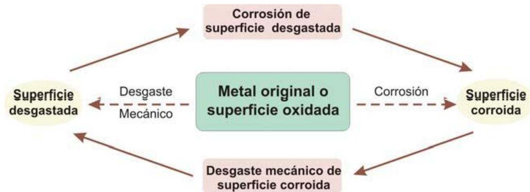
Figura 11. Relación entre corrosión y desgaste.
