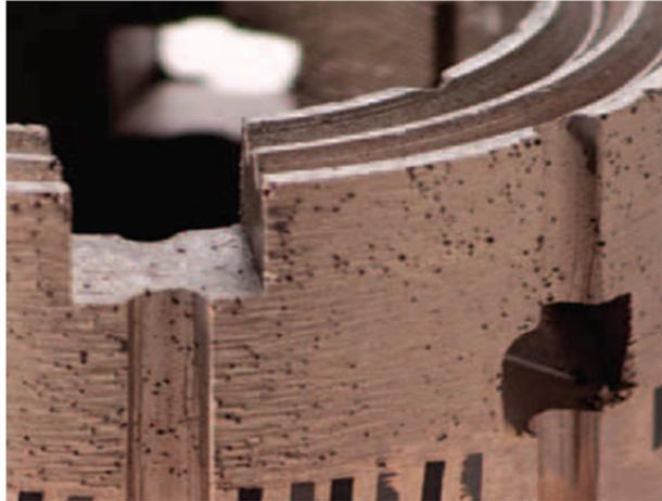
*Figura 4.2. Corona con recubrimiento y sin insertos.*
