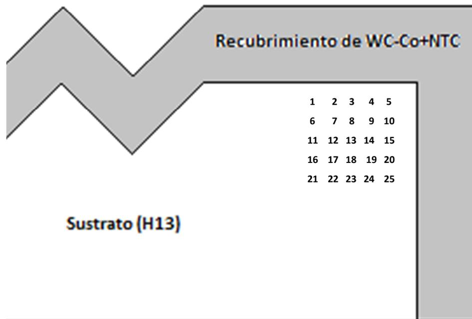
Figura 6.4. Representación esquemática de las indentaciones en el sustrato.
