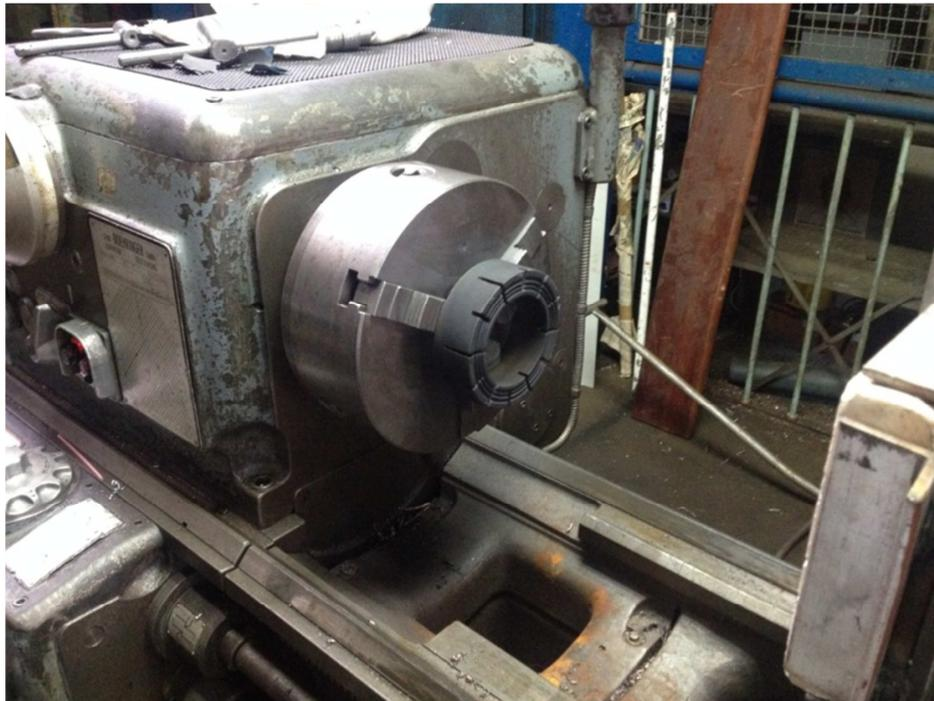
*Figura 5.6. Torno de torrecilla horizontal marca Boehringer, de 2 m. de bancada.*
