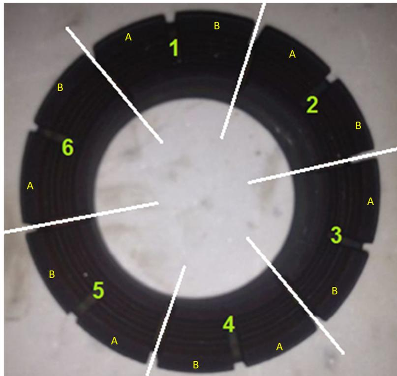
*Figura 7.4. Esquema de la división de la corona en seis probetas.*
