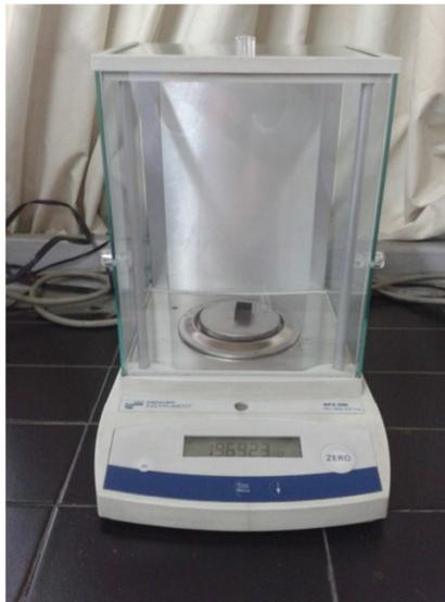
Figura 6.11. Balanza analítica marca Denver Instruments, modelo APX-200.
