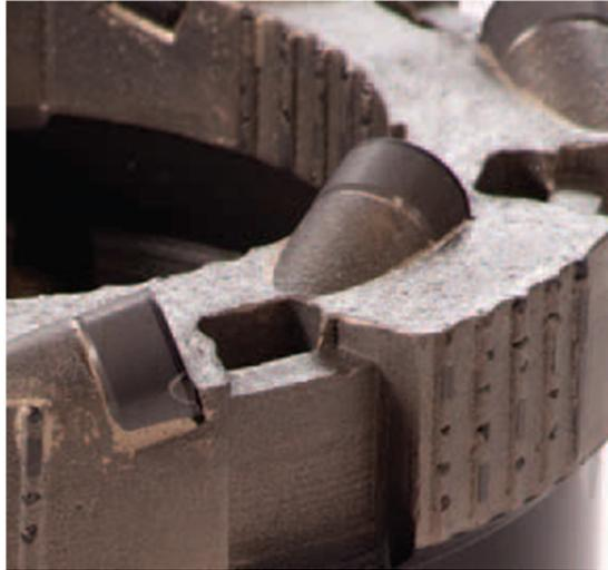
*Figura 4.4. Corona con insertos de Diamante Policristalino Sintético (PDC).*
