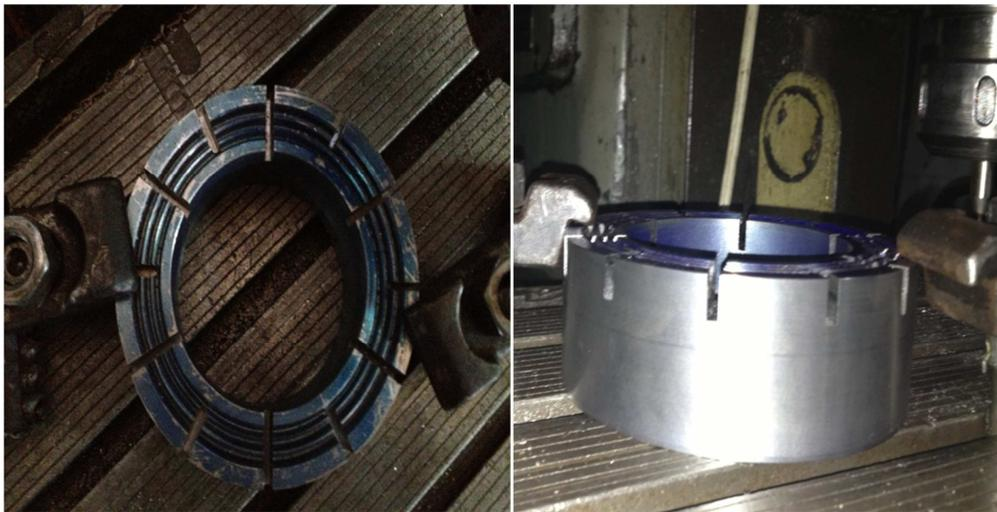
Figura 5.8. Corona para broca de extracción de núcleos, antes de ser recubierta.
