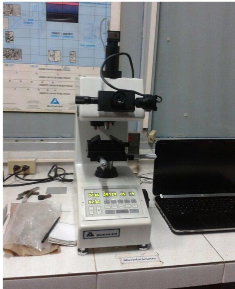
Figura 6.3. Micro-durómetro Marca BUEHLER.
