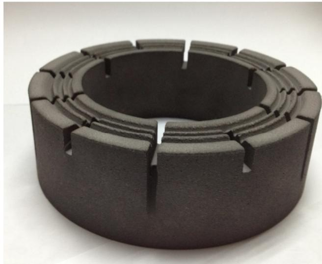
*Figura 5.9. Corona para broca de extracción de núcleos con recubrimiento de Carburo de Tungsteno a través de un Termorociado por HVOF.*
