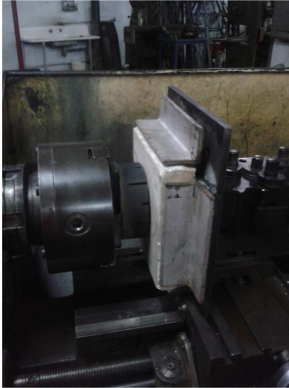
*Figura 6.7. Montaje del ensayo de desgaste.*
