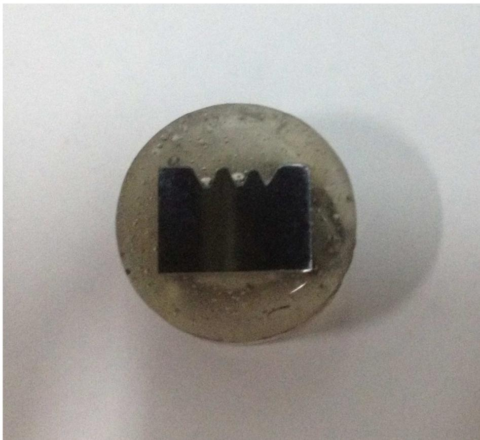
*Figura 6.2. Probeta pulida para el ensayo de microindentación.*
