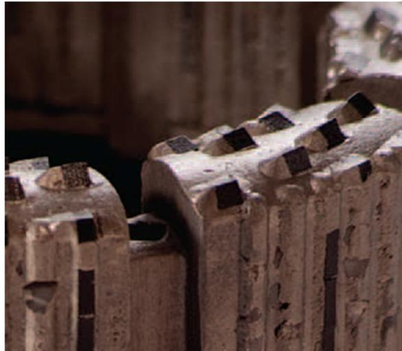
*Figura 4.3. Corona con insertos de diamante térmicamente estable (TSD).*
