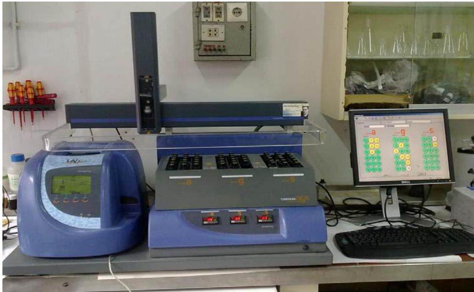
*Figura 3.10. Medidor de Estabilidad Turbiscan LA*
