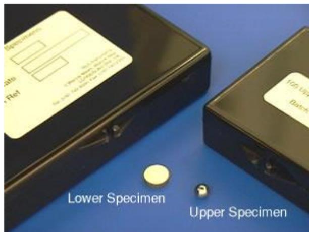
Figura 3.6. Placa y Bola PCS Instruments acero AISI 52100
