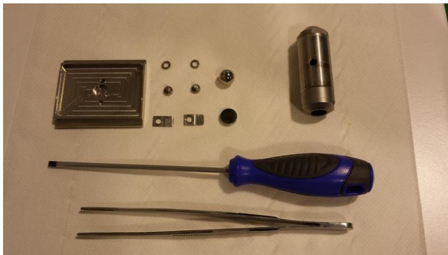
*Figura 3.12. Base de la probeta y portabola del tribómetro.*
