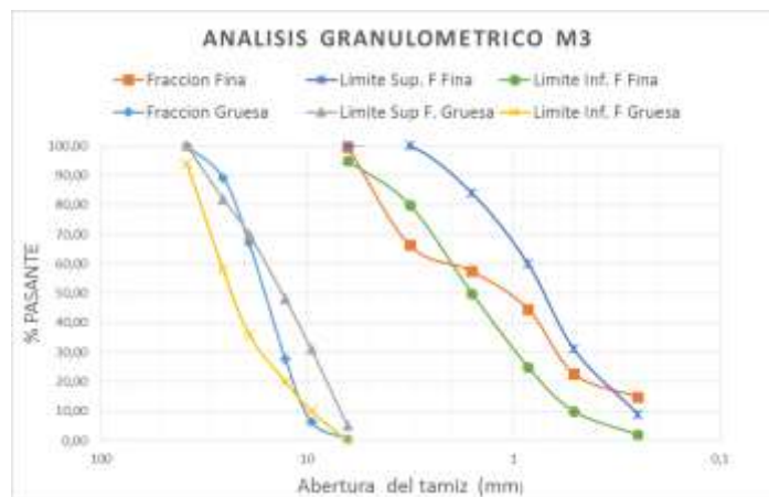
Figura 8. Análisis Granulométrico para la fracción fina y gruesa de la muestra M3. Mampostería de arcilla triturada Fuente: Elaboración Propia
