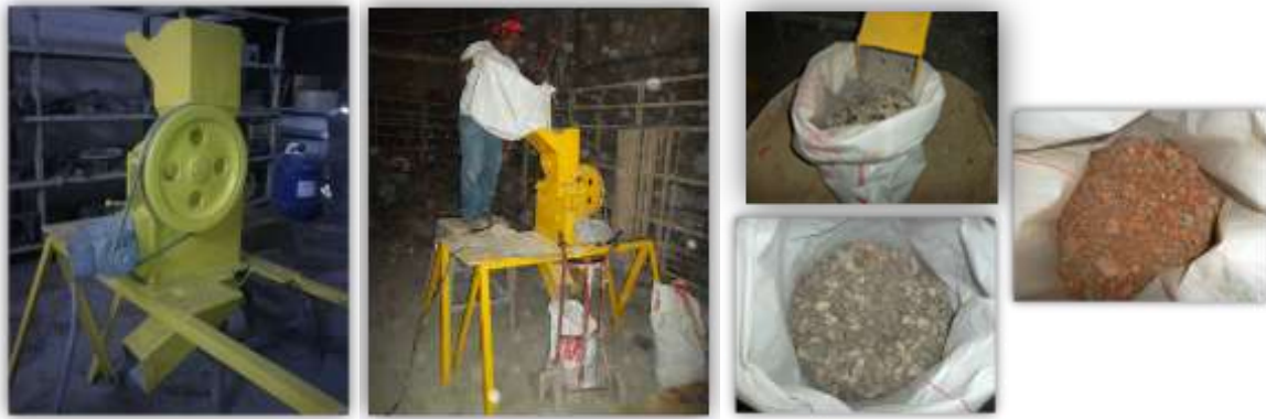
Figura 5. Trituradora empleada, proceso de trituración y material triturado según su tipología. Pre- trituración y homogenización manual. Fuente: Elaboración Propia
