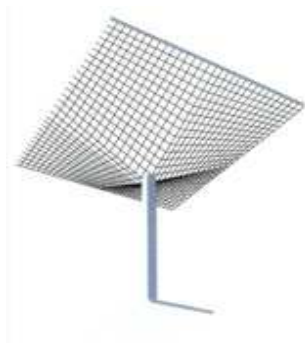
Figura 8. Cuatro unidades de paraboloides hiperbólicos configurados espacialmente como paraguas invertidos.
