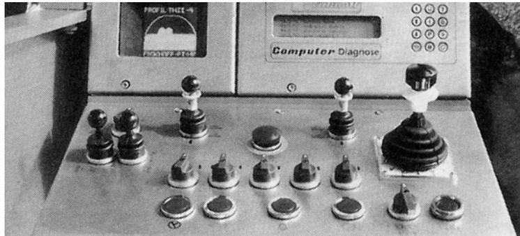
Foto 7.2. Consola de control de un minador (AC - Eickhoff).
