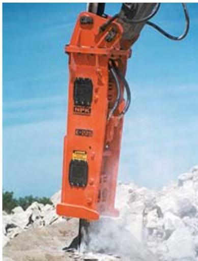
Foto 12.1 Martillo hidráulico de 5900 kg marca NPK
