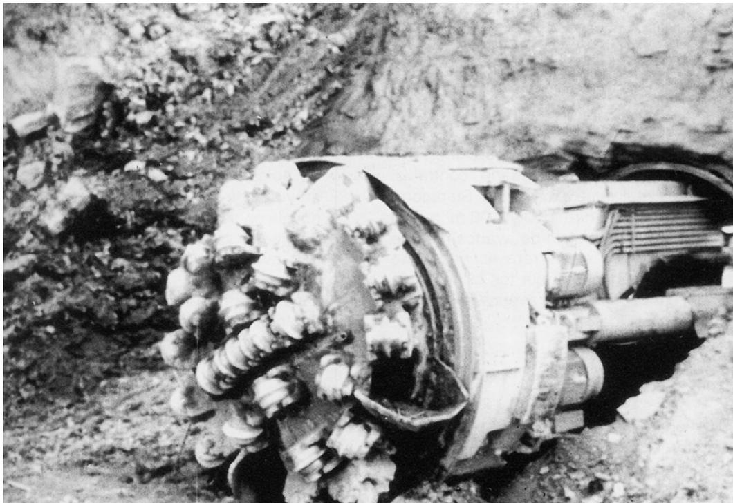
Foto 8.2. Cabeza de una TBM Robbins de 3,20 m de diámetro.
