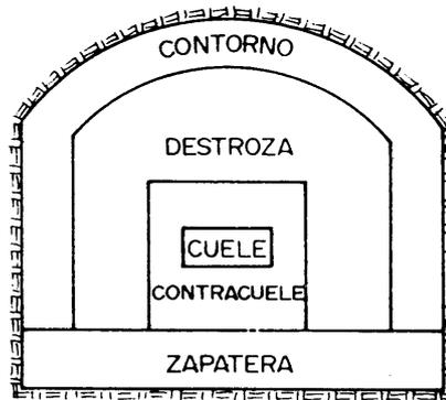
Figura 9.42. Zonas de una voladura en túnel.
