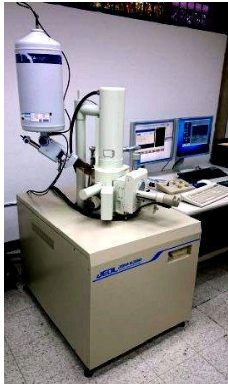
Figura 17 Microscopio Electrónico de Barrido Jeol JSM-6390 con sistema de adquisición de imágenes INCA de Oxford Instruments.
