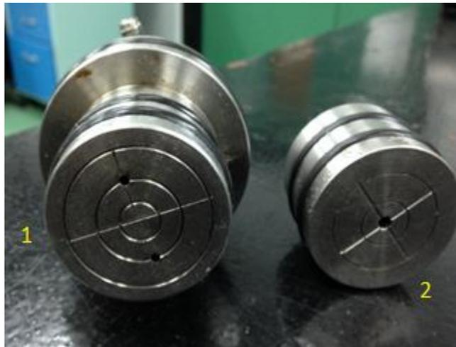
Figura 49. Caras que dan hacia el núcleo: 1) Tapa fija. 2) Tapa móvil.
