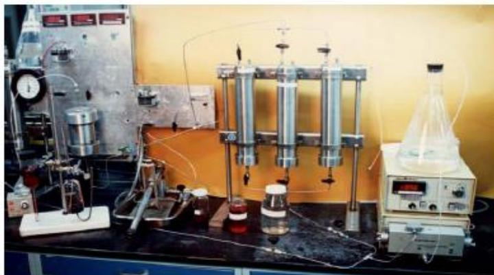
Figura 13. Sistema para inyección de solventes. Tomada de “Interacciones Roca-Fluido Para Yacimientos” por Y. Araujo, 2004.
