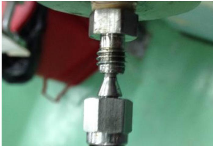
*Figura 59.* Montaje del cono, anticono y la tuerca
