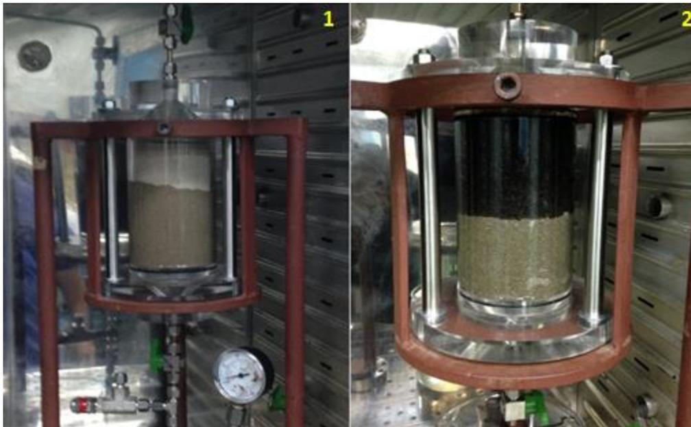
*Figura 78.* Desplazamiento del agua (1) y crudo (2) en presencia del medio poroso.
