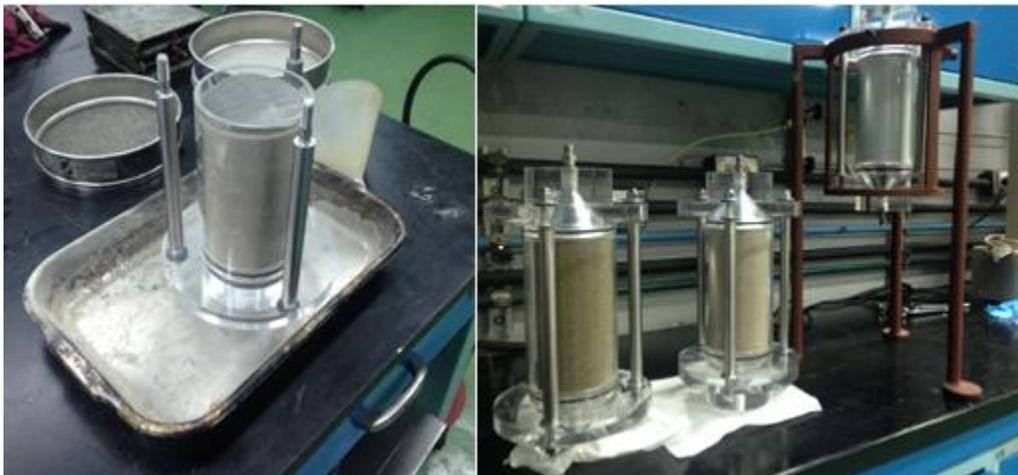
*Figura 75.* Llenado de las celdas con tres tipos de arena diferente.
