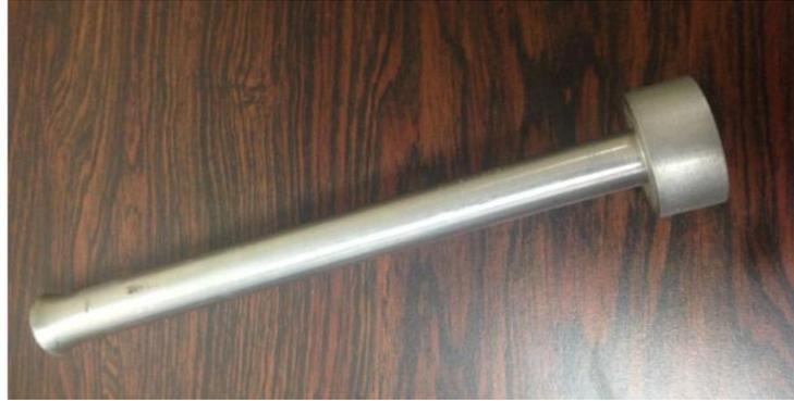
*Figura 77.* Herramienta utilizada para la compactación de la arena.
