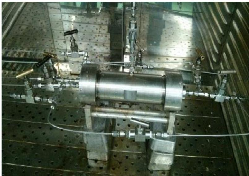
*Figura 47. Celda triaxial.*
