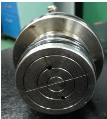
*Figura 73.* Geometría de la tapa fija de una celda triaxial.
