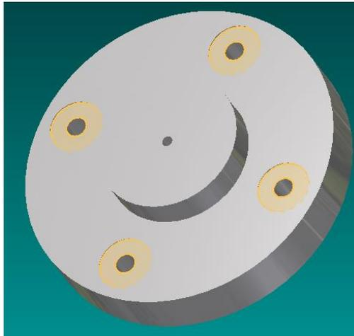
Figura 110. Área de contacto entre los pernos y la tapa.
