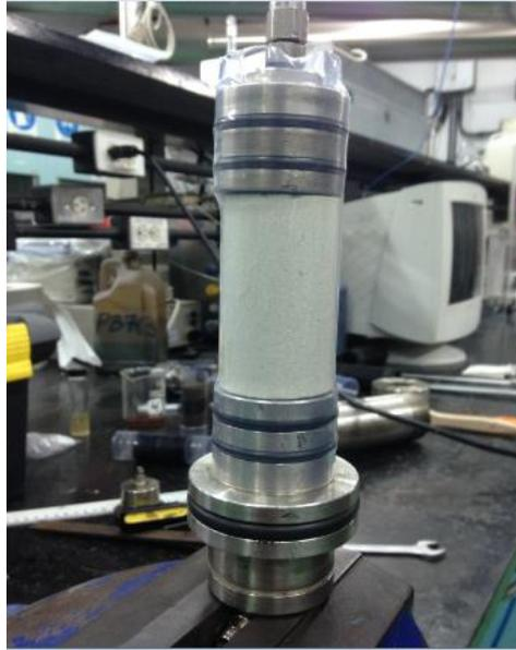
*Figura 52.* Termoencogible luego de ser calentado.
