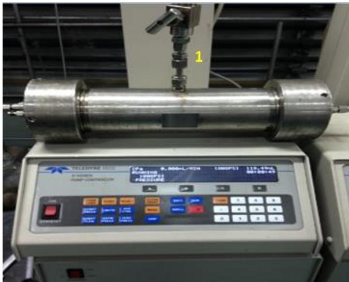
*Figura 60.* Inyección de agua por la entrada (1), para simular la presión de confinamiento.
