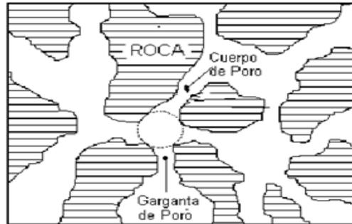
Figura 10. Esquema de un medio poroso. Tomada de “Interacciones Roca-Fluido Para Yacimientos” por Y. Araujo, 2004.
