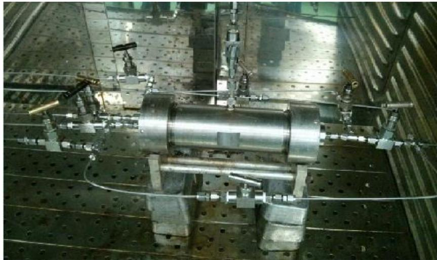
*Figura 1.* Celda triaxial para pruebas de desplazamiento.
