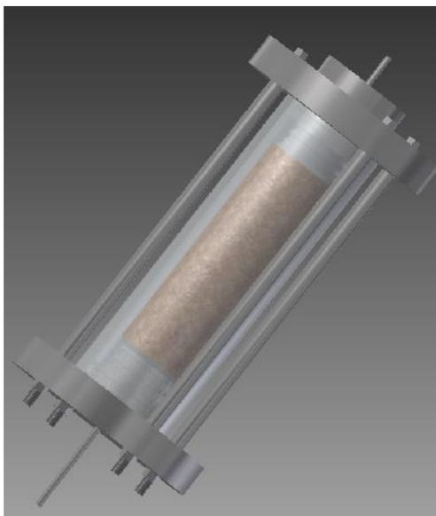
*Figura 79.* Propuesta final para la celda visual de desplazamiento para crudos pesados y extrapesados.
