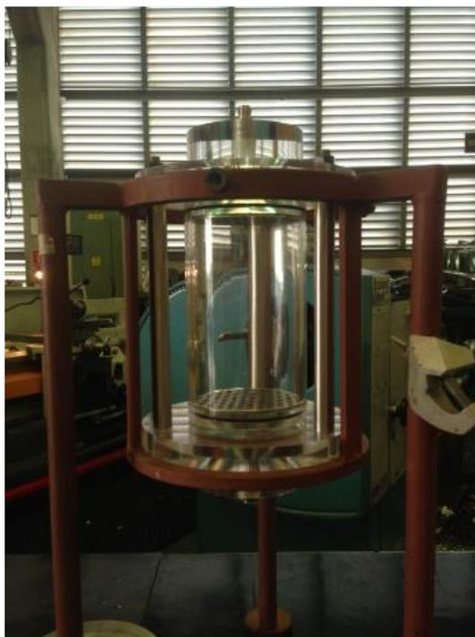
*Figura 72.* Prototipo de la celda visual de desplazamiento.
