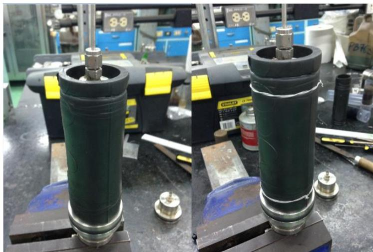
*Figura 53.* Manga de viton y sujeción de la misma con alambres.
