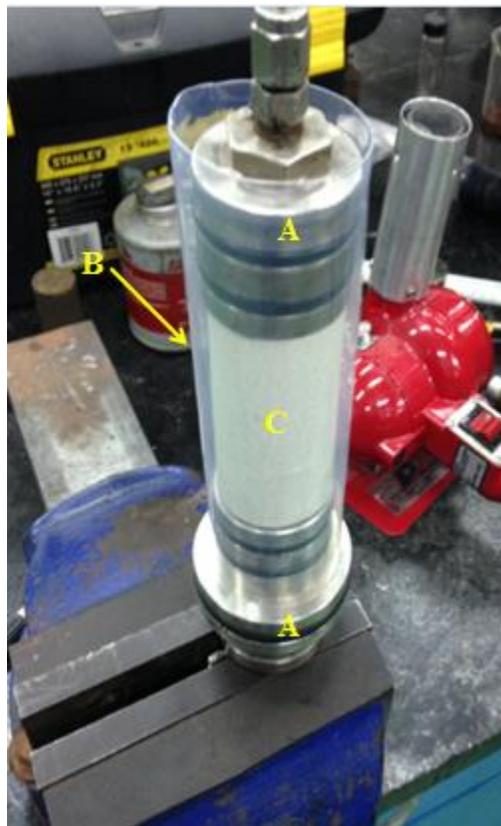
*Figura 51.* Montaje de las tapas (A) y el termoencogible (B) sobre el núcleo (C).
