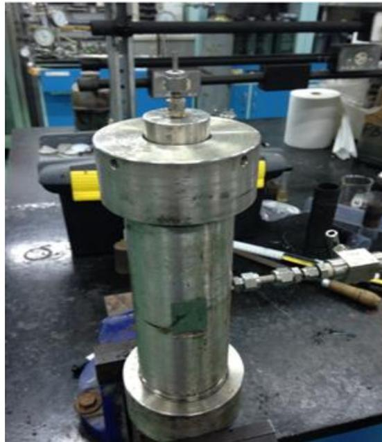
*Figura 57.* Montaje de la última tapa hueca enroscada a la celda.
