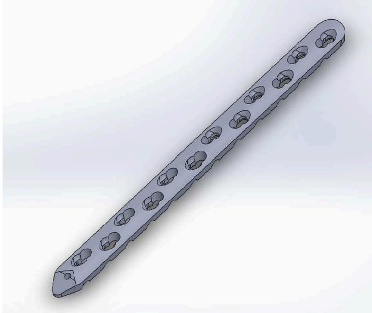
**Figura 3.1 Placa de bloqueo para diáfisis de fémur y tibia (12 agujeros)**
