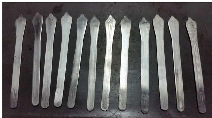
**Figura 3.13 Placas planas de tibia distal obtenidas**
