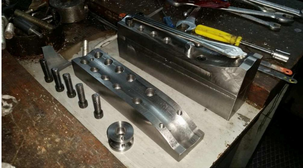
**Figura 3.4 Troquel distal de tibia (punzón boca abajo) y LCP colocada sobre la matriz**
