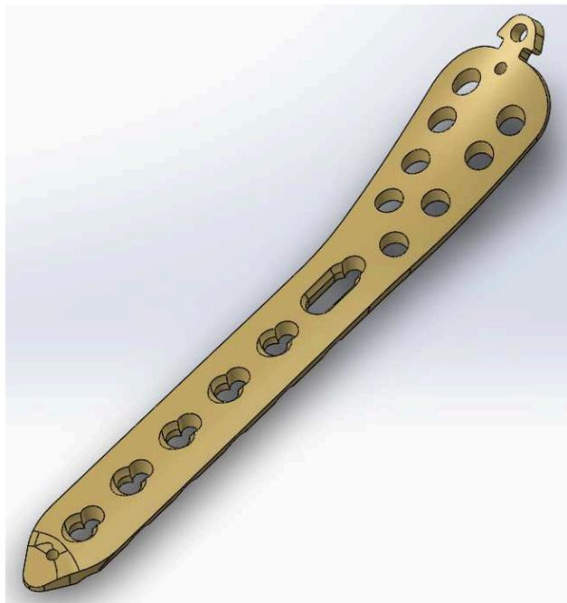
**Figura 3.2 Placa de bloqueo para distal de tibia (6 agujeros)**
