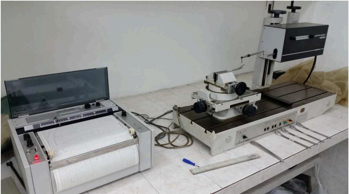
**Figura A.3 Copiador de Perfiles de la Escuela de Ingeniería Mecánica UCV CONTRACER CA-102 MITUTOYO**
