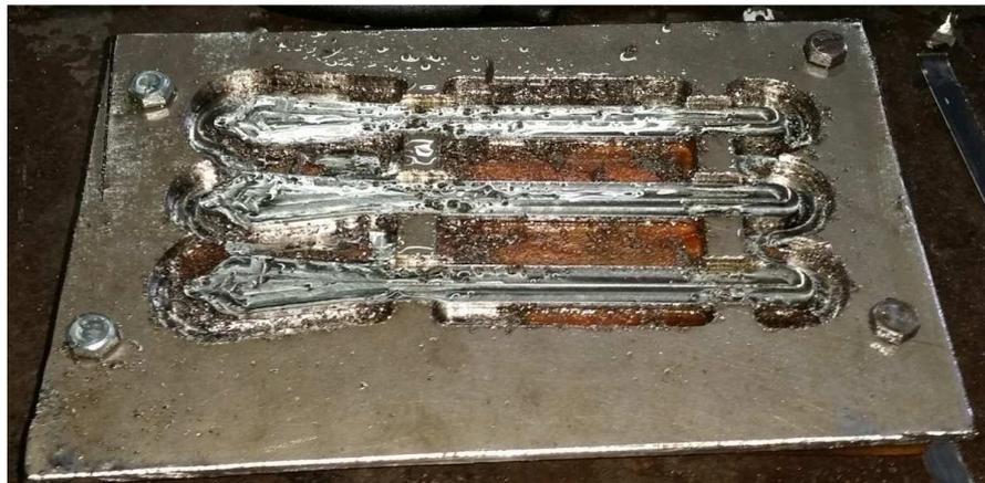
**Figura 3.12 Instrumental para el corte de la LCP de tibia distal de 10 agujeros luego de operar con el CNC**
