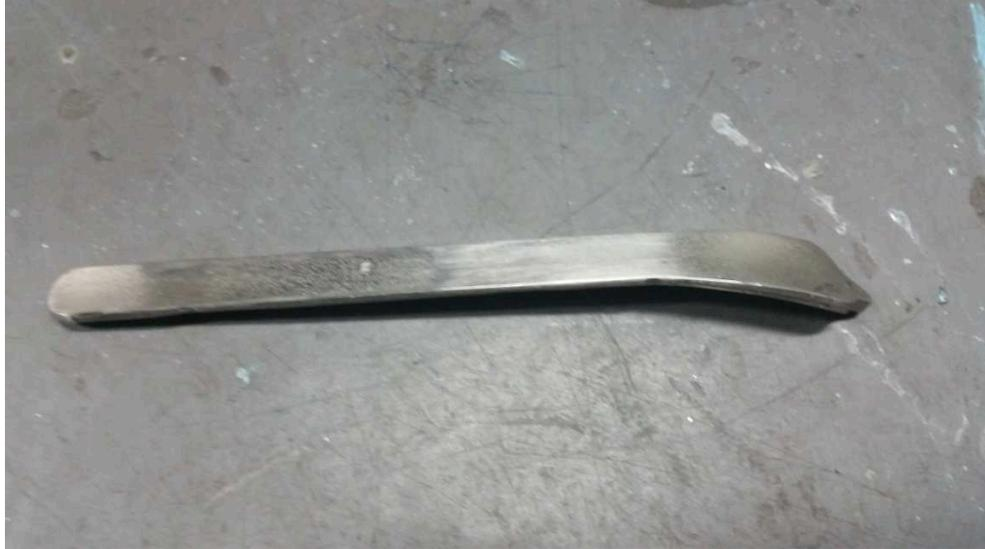
**Figura 3.17 Placa de tibia distal doblada. Vista superior**
