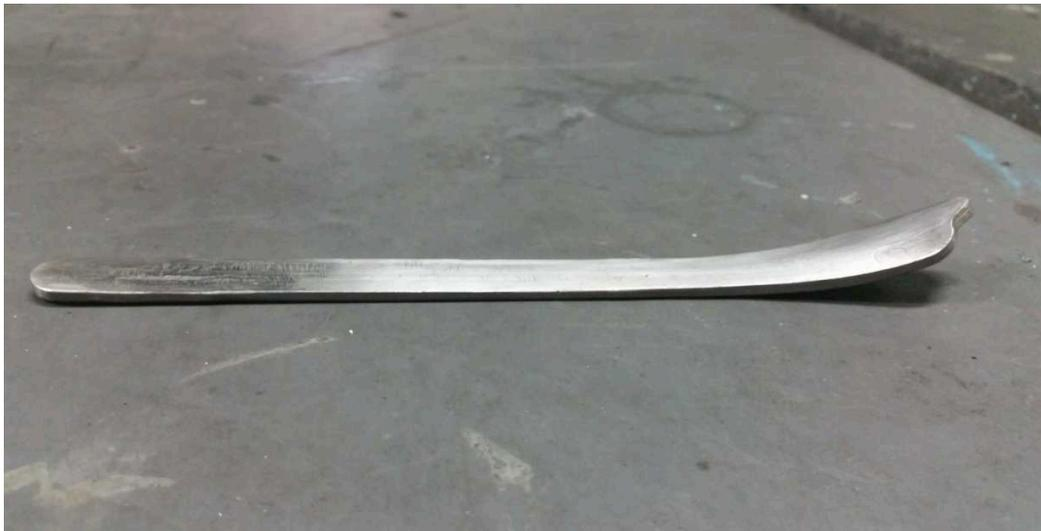
**Figura 3.18 Placa de tibia distal doblada. Vista inferior**
