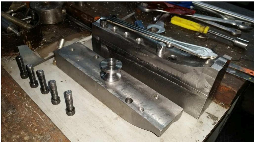
**Figura 3.5 Troquel distal de tibia (punzón boca arriba) y LCP colocada sobre la matriz**
