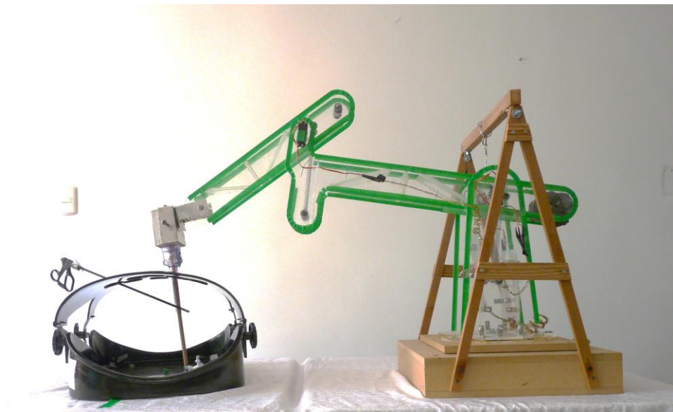
Figura 4.8.1. Suspensión fabricada para el giro de la base (en madera)
