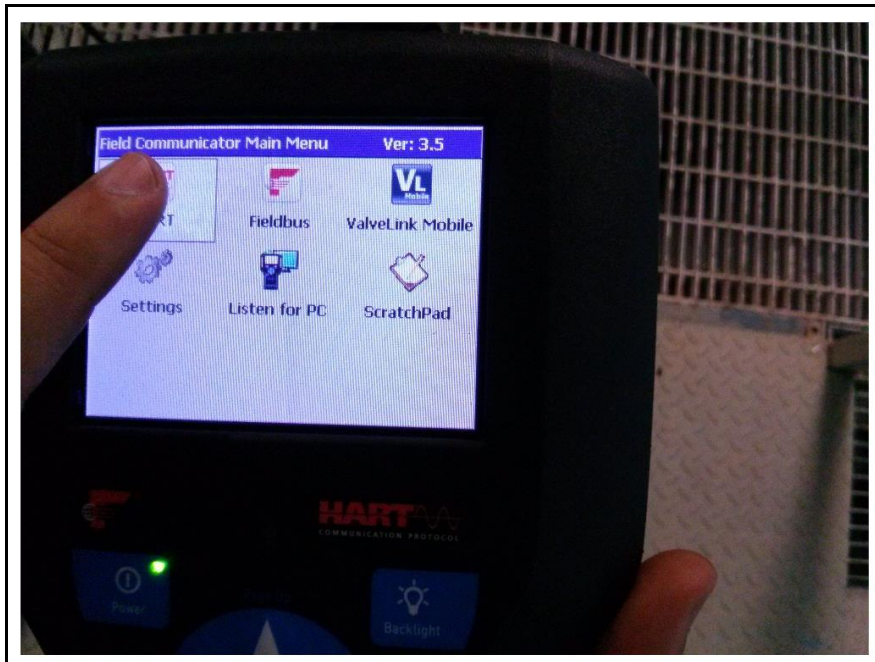
Figura N° 14 Encendido del HART-375 conectado a un transmisor de señal.
