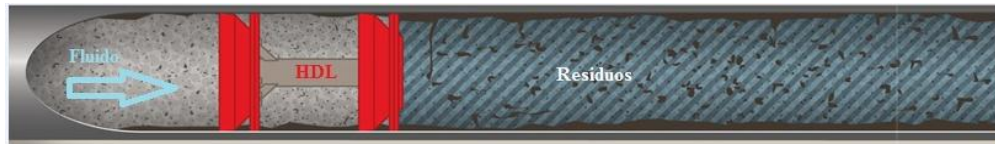
Figura 1: Herramienta de limpieza en una línea de tubería
