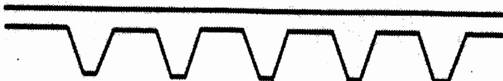
Figura A.4.4.1.4.2 Construcción típica de viguetas de concreto
