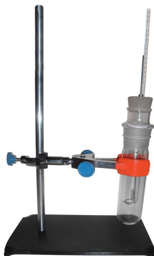
Figura 20. Montaje para Medición de Pto. De Anilina
