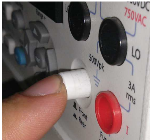
Figura 14. Botón del multímetro digital para realizar la medición de corriente.
